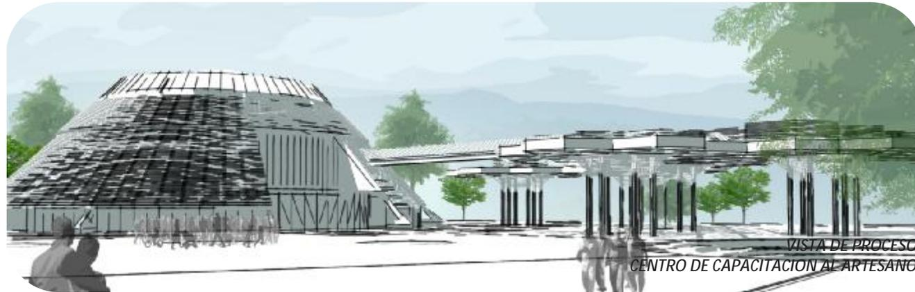
La planta circular del edificio permite que todos los espacios se abran hacia el exterior, aprovechando al máximo la iluminación y ventilación natural, ayudando a la integración del adentro y afuera por medio de jardines y espejos de agua que vienen desde las plazas exteriores hasta el interior del edificio.
