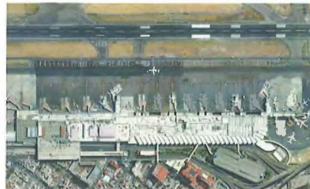
Img 36. Configuración de terminales de concepto lineal.
