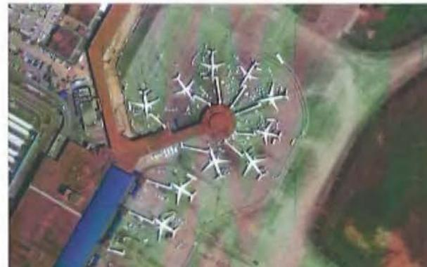
Img 38. Configuración de terminales de concepto satélite.
