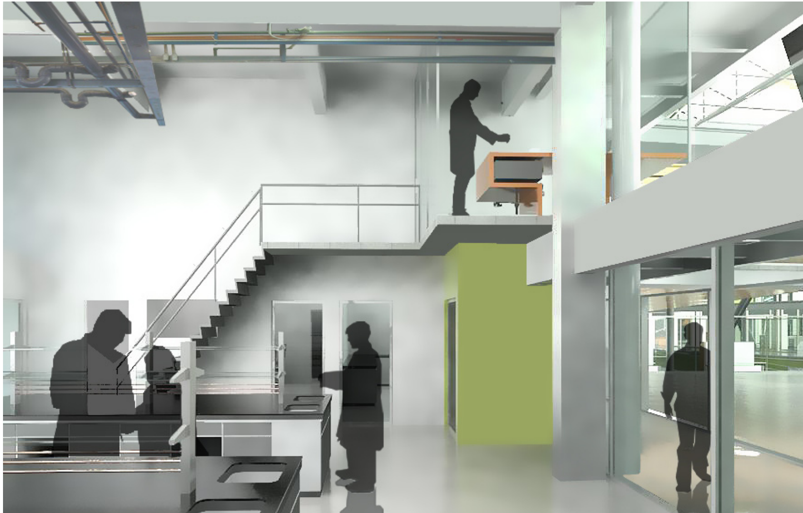
Fig. 82 El uso de dobles alturas en laboratorios facilita la instalación de ductos e instalaciones sin interferir con la dinámica de los espacios de trabajo. Combinado al uso de grandes ventanales permite dotar a los mismos de mayor iluminación natural y exponer el trabajo de laboratorio a personas ajenas al mismo.
