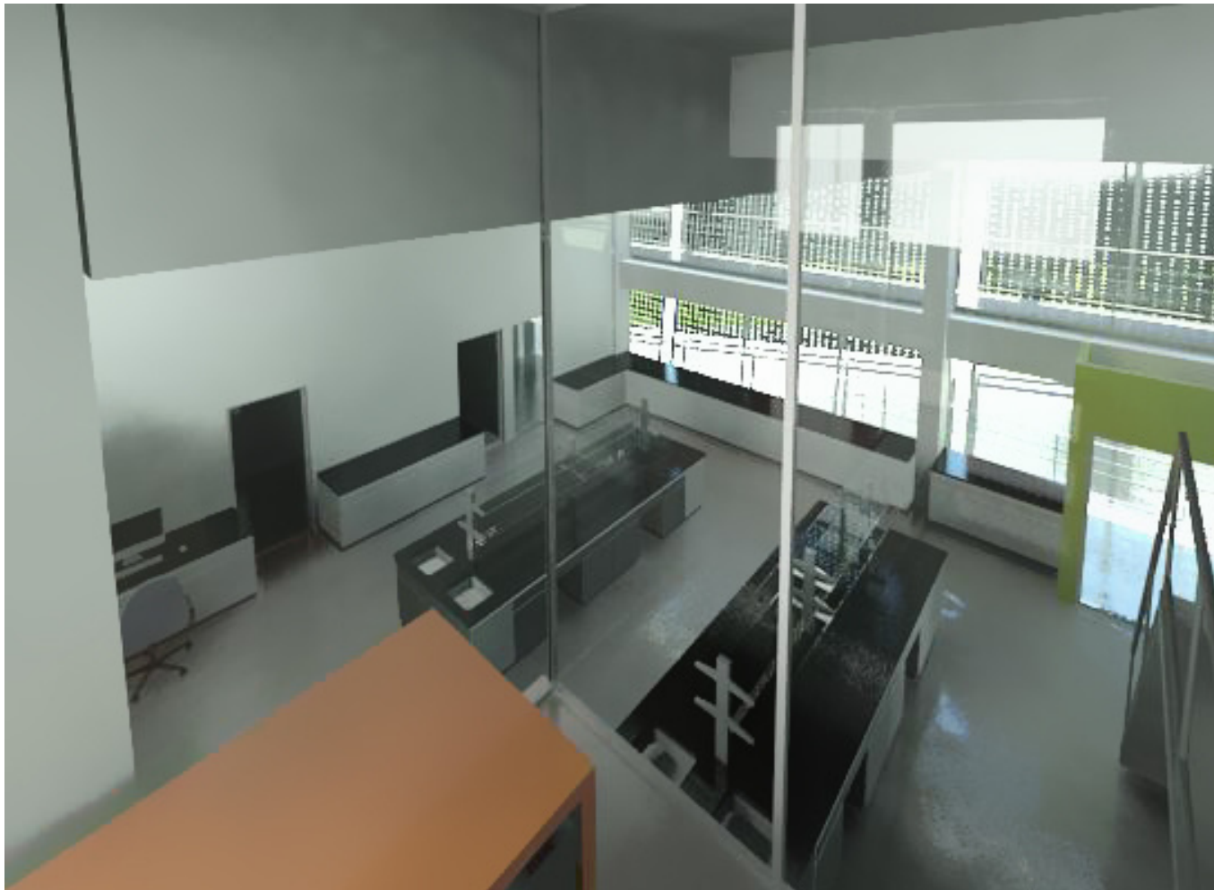
Fig. 85 El uso de dobles alturas en laboratorios posibilita la colocación de cubículos de monitoreo en un nivel superior, facilitando la labor de supervisión para los directores de investigación
