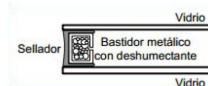
Esta idea se utiliza frecuentemente y es conocida como panel doble vidriado hermético, DVH. Para evitar la condensación interna se utiliza un bastidor hueco con deshumectante; tiene la ventaja de que se fabrica industrialmente y la desventaja de que la separación entre ambos vidrios en general es reducida.
