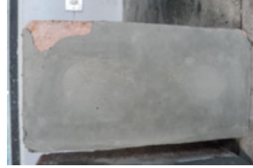
Bloque de arcilla #2 con capeo . Imagen 19
