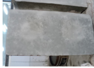
Bloque de arcilla #3 con capeo . Imagen 20
