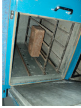
Colocación bloques de arcilla dentro del horno. Imagen 37
