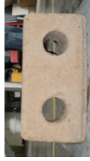
Ladrillo después de permanecer 24 h. en el horno. Imagen 29
