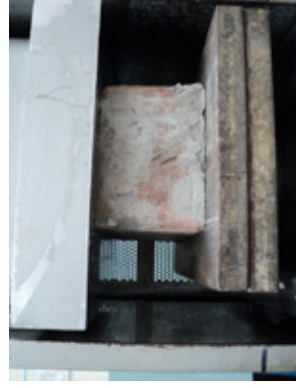
Colocación bloques de arcilla dentro de máquina para prueba de compresión FORNEY. Imagen 40
