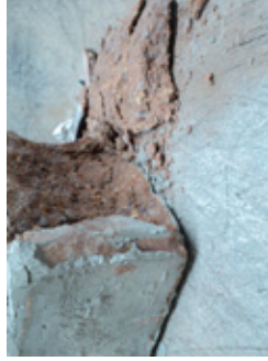
Bloques de arcilla después de la prueba de compresión. Imagen 42
