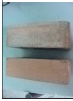
Variación notable de tamaño entre un bloque de arcilla y otro. Imagen 48
