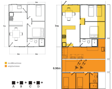
3. adecuaciones y modificaciones
