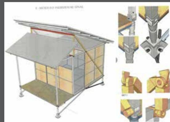
IM.30. El diseño de detalles móviles (no rígidos) permite que las estructuras sean flexibles y de fácil manejo.
