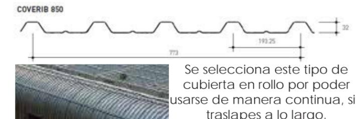
IM.131. Detalle cubierta de acero con protección aislante multiestrato.
