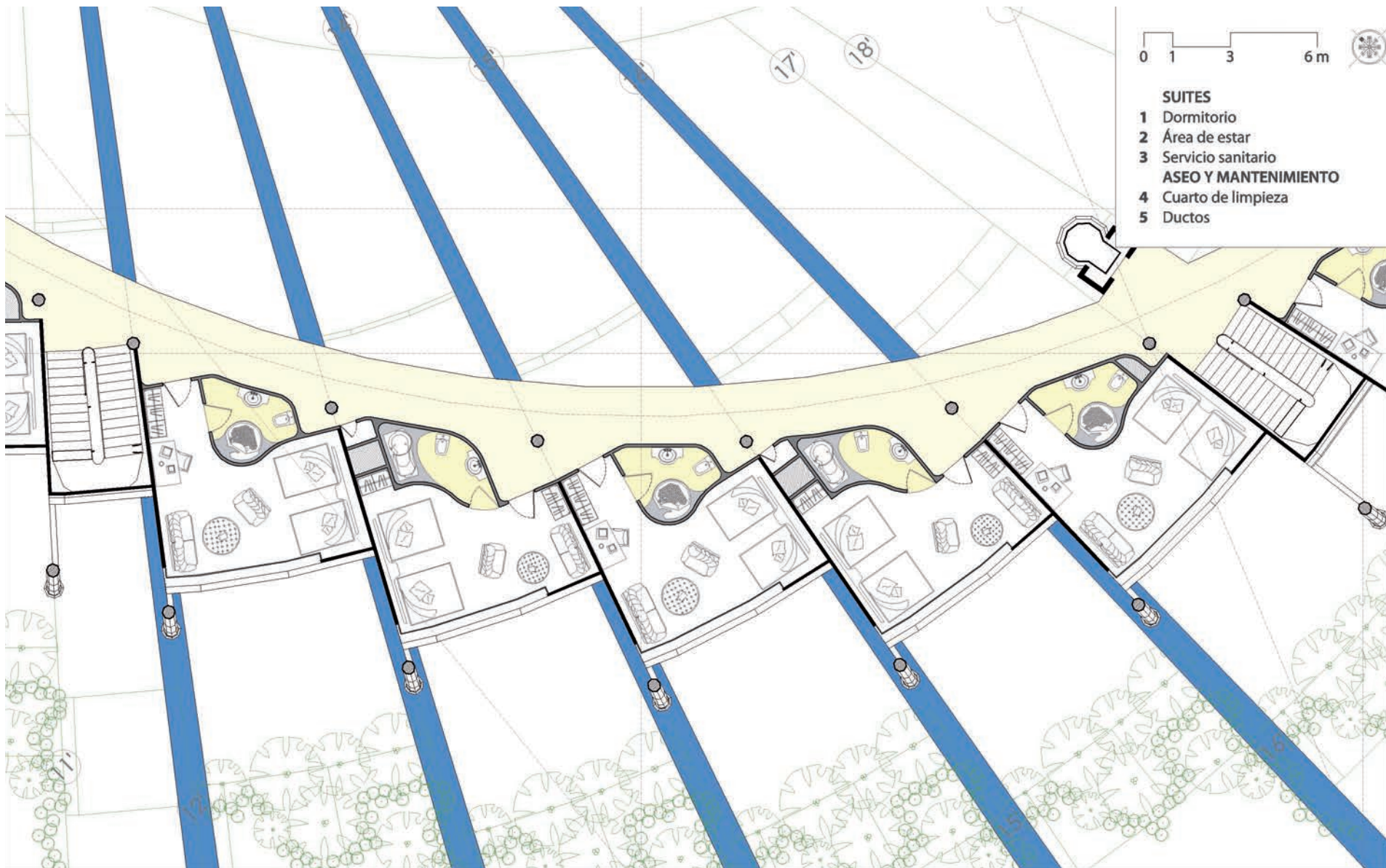
Figura 79. Planta Arquitectónica las Habitaciones tipo Suite, Niveles 2 y 3, 0+5,85 m y 0+9,65 m snpt. Fuente: propuesta personal, 2013.
