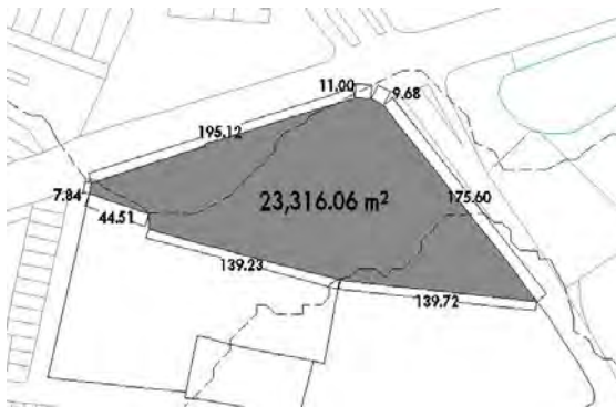
Fig. 85: Planta del lote con curvas de nivel.
