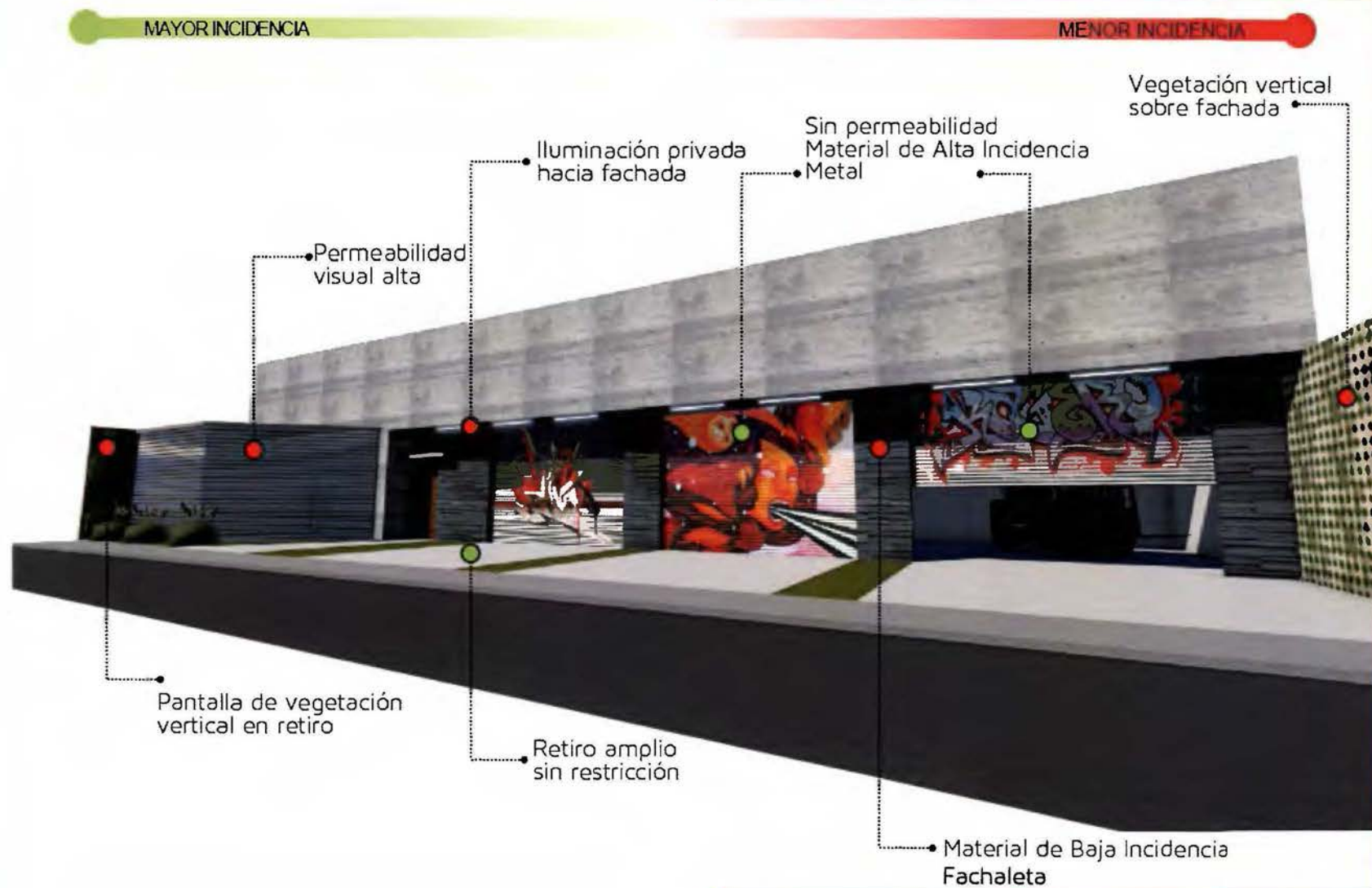
Imagen 6.3.1.c Render esquemático de la utilización de los parámetros de diseño para el manejo de bordes urbanos con incidencia o no del arte grafiti, según uso específico de industria. Elaboración propia.
