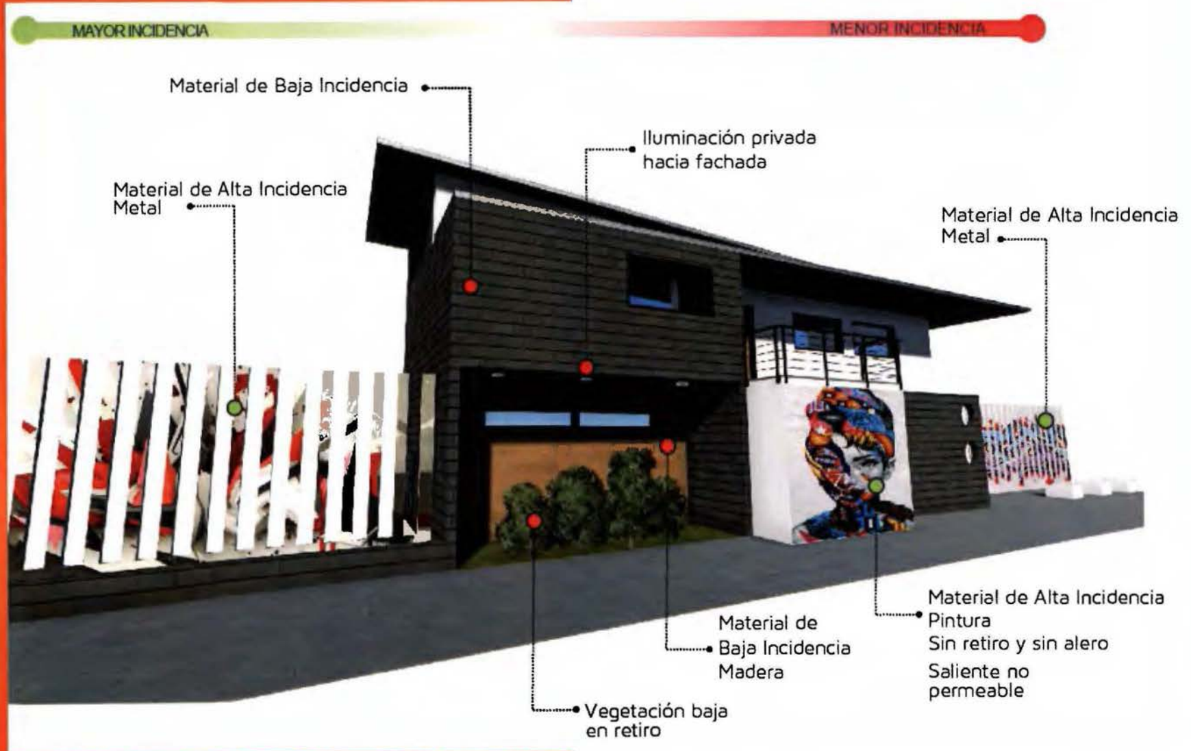
Imagen 6.3.1.d Render esquemático de la utilización de los parámetro de diseño para el manejo de bordes urbanos con incidencia o no del arte grafiti, según uso específica de vivienda. Elaboración propia.
