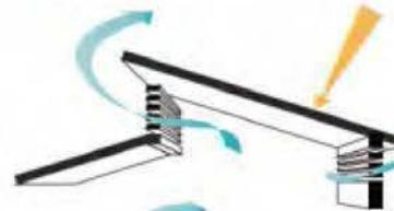
Fig. C.40. Funcionamiento de monitor bilateral combinado con espacio ventilado. (elaborado por G.D.B.)
