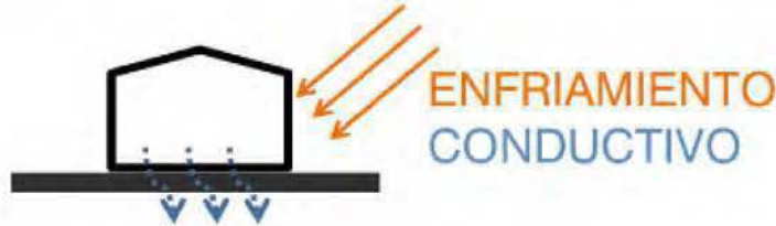
Fig. C.28 Diagrama de enfriamiento conductivo (transferencia de calor al suelo). Elaborado por autor.
