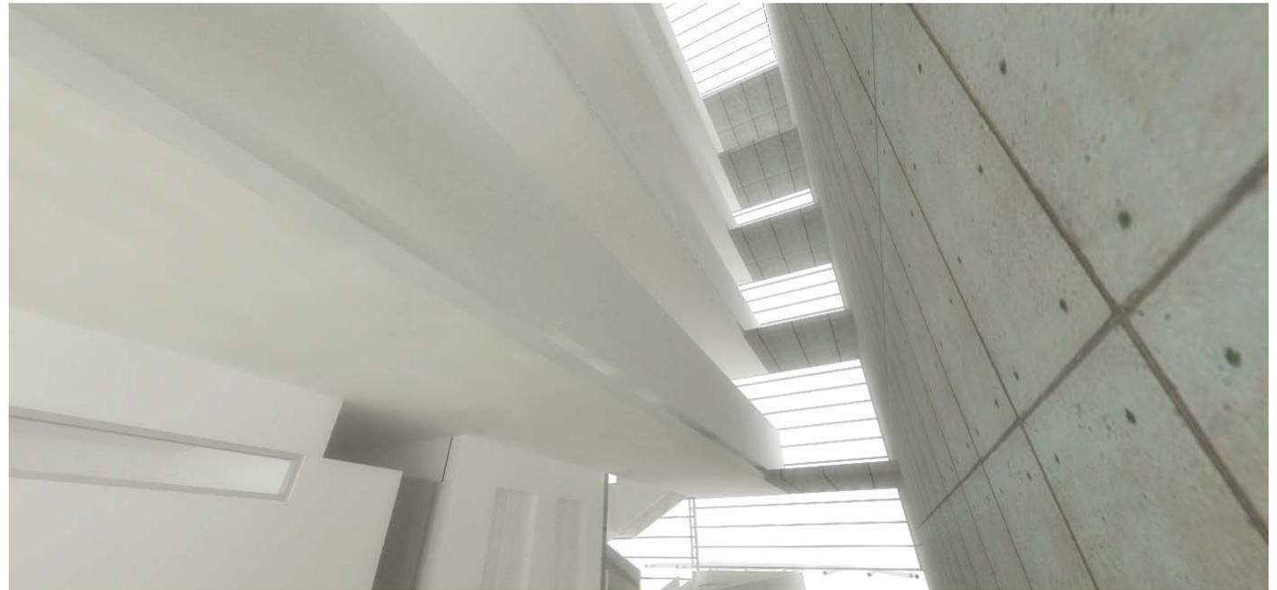
La zona de las rampas en los últimos 4 niveles será un espacio vacío con luz norte, para promover la apertura y la ventilación, todas las barandas serán de 120cm. de alto para reducir la posible sensación de vértigo, y frente a ventanales siempre se contará con un murete de 40cm. de alto mínimo, para que los usuarios de sillas de ruedas tengan una sensación de tope.
