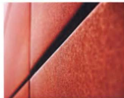
62. Acero Corten: tipo de acero con una composición química que crea una película de óxido que impide que este prosiga hacia el interior de la pieza
