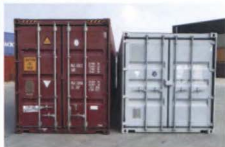
112. Comparación entre los Dry Van tipo SD y HC.
