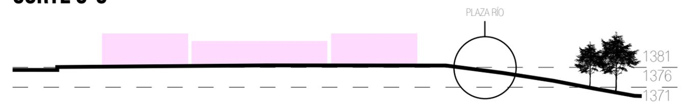
Como se aprecia en el perfil de terreno C-C, la sección longitudinal de terreno se desarrolla de manera muy regular y la Plaza Río se aprovecha de los desniveles que se disponen hacia el cañón del río.
