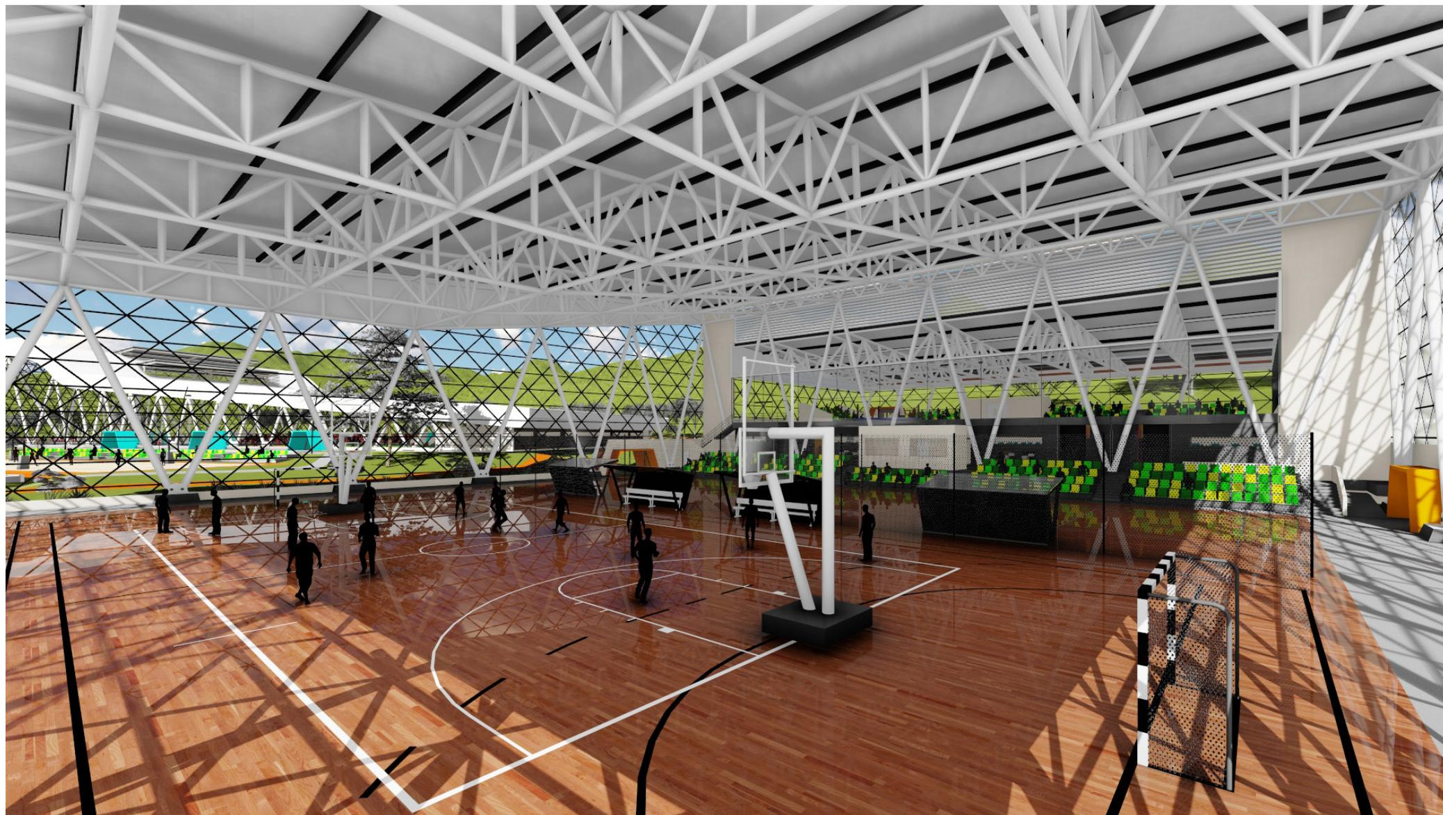
Para mantener un mismo lenguaje, la estructura del pabellón de combate y pelota, se diseña en acero. Las canchas de juegos con pelota, requieren una mayor altura, por lo cual, los servicios de apoyo y pabellón de combate se disponen en un único bloque de dos niveles.
