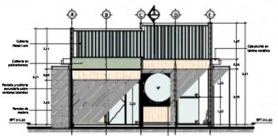
ELEVACION FRONTAL PREESCOLAR TIPO 2 ESCALA 1:50
