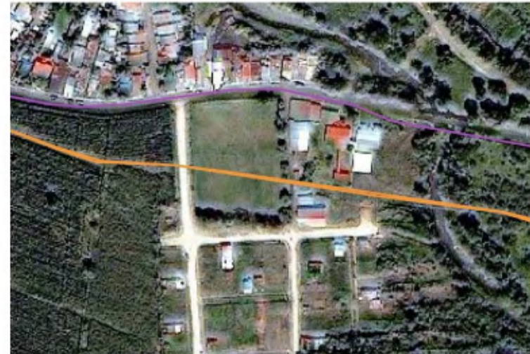
Ilustración 10: Paso de Poliducto de 12" (línea morada) y de 6" (línea naranja). Fuente: http://www.arcgis.com/apps
