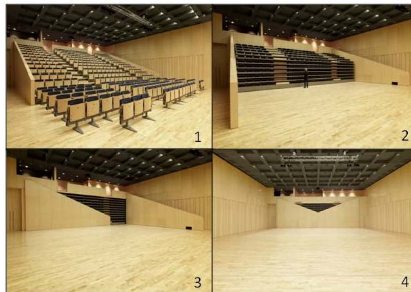
Imagen 35: Secuencia de Uso de tribunas telescópicas, imágenes cortesía de Figueras, obtenidas de: http://www.figueras-usa.com/uk/projects/multipurpose-spaces/276_latlantida-centre-darts-esceniques-sala-polivalente.html
