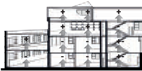
Gráfico G15. Corte transversal del edificio. Debido al grosor de los muros de concreto, el edificio se percibe a lo interno un nivel menor de temperatura, sobretodo en los niveles inferiores. Elaboración propia.
