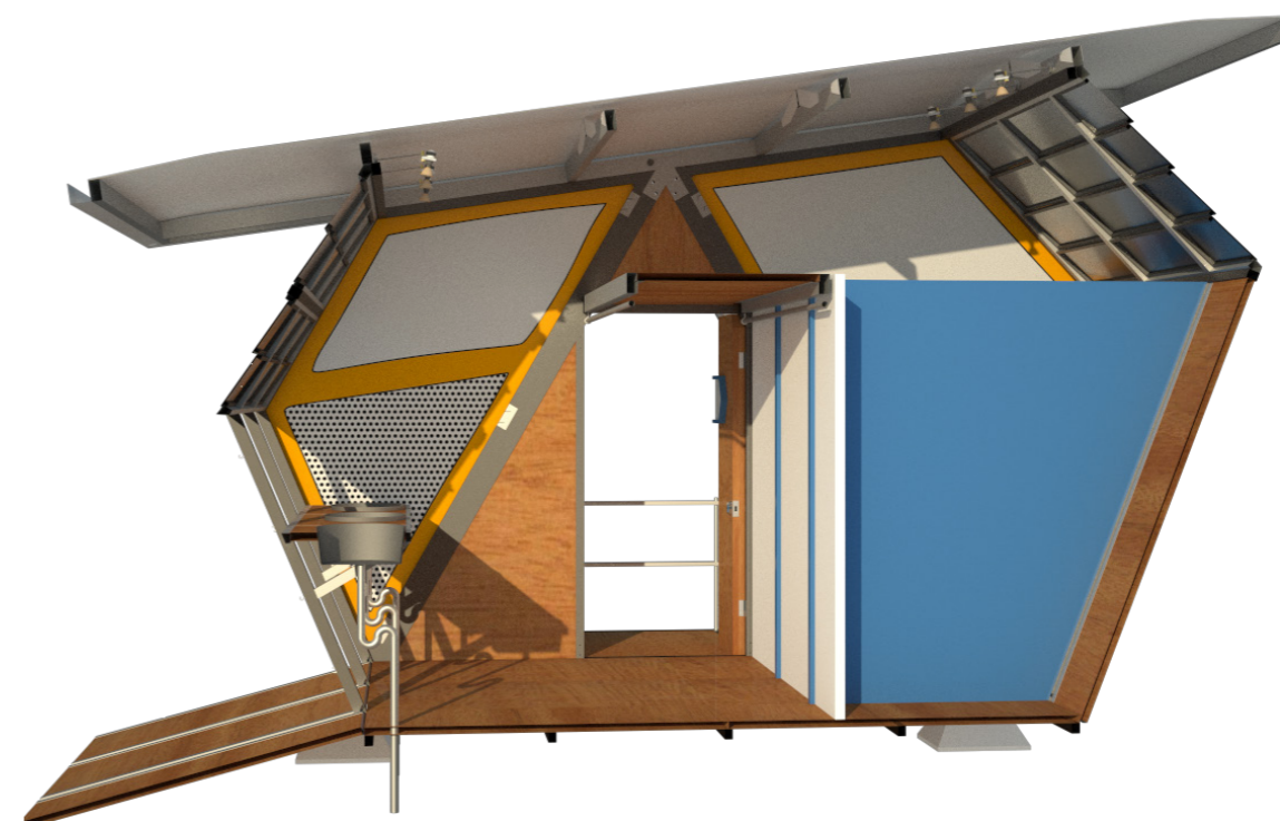
Imagen N° 102. Corte espacial del MAD-Sanitario con tres duchas y tres lavamanos o pilas. Autoría propia.
