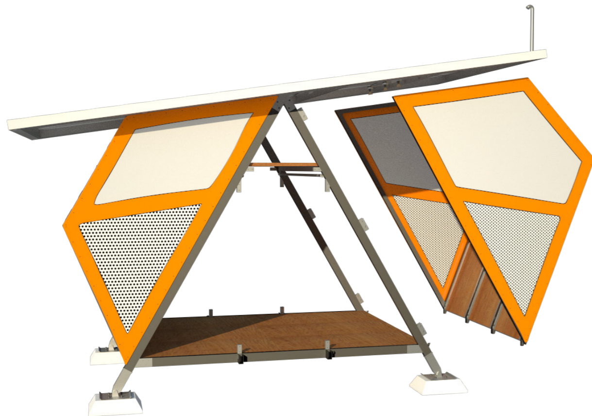
▼ Imagen N° 87. Colocación de la segunda Estructura Secundaria en la Estructura Principal. Autoría propia.
