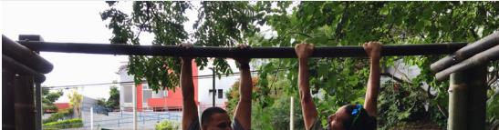
Img. 27 | Prueba de fuerza con viga de 2 cañas de bambú negro (no apto para construcción, solo elementos en espacio interior), 10cms de diámetro y 3m de largo con 300kg.
