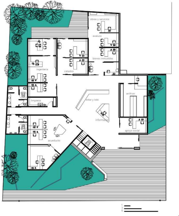
Planta Arquitectónica 1er Nivel Edificio 2 - Oeste
