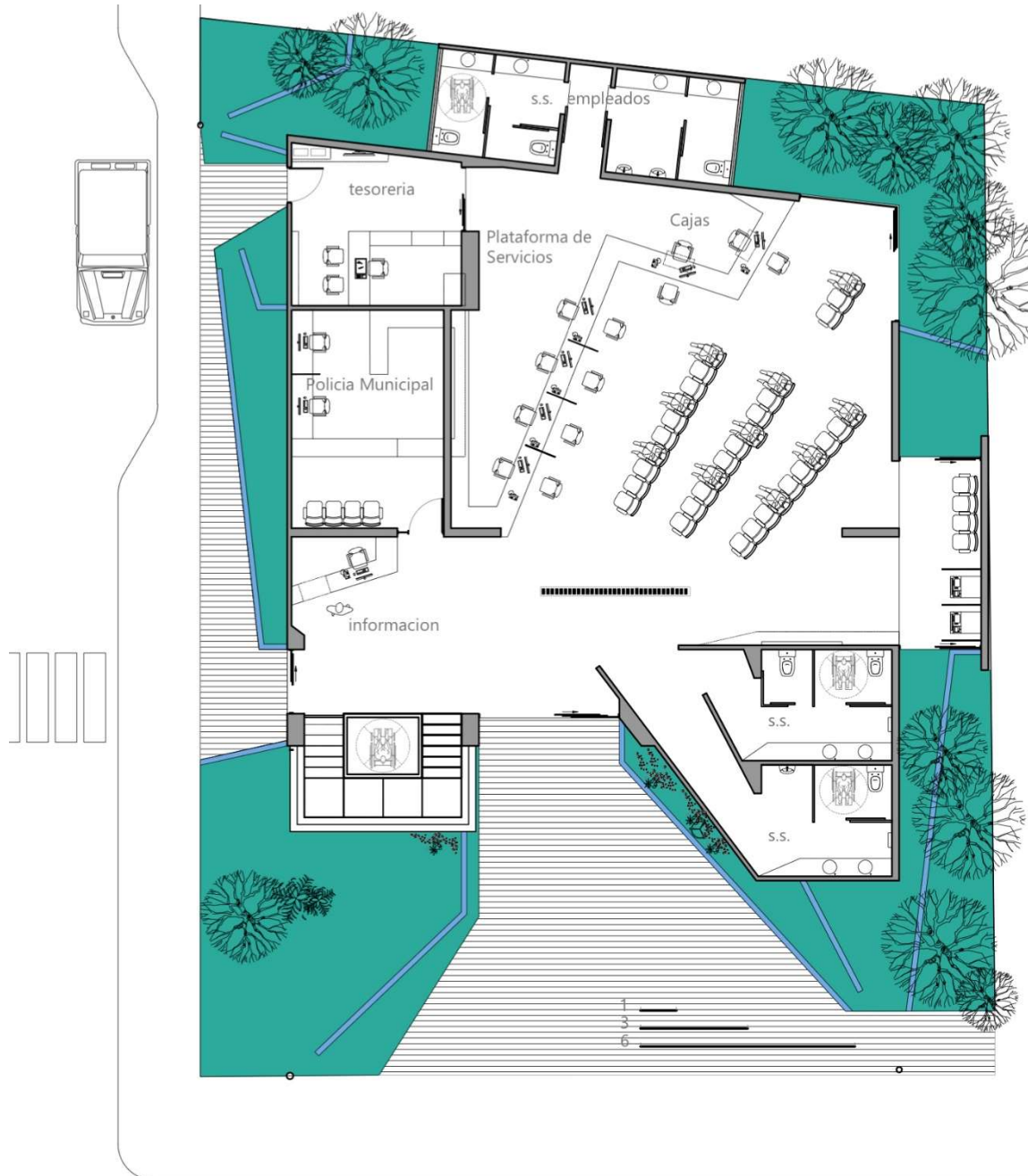
Planta Arquitectónica 1er Nivel Edificio 1 - Este
