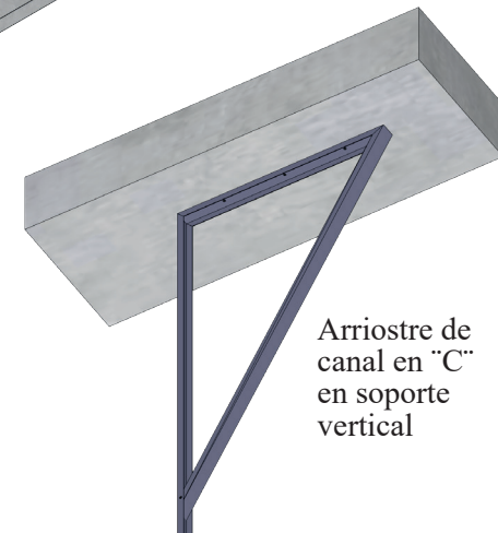
2. Soporte a la losa de contrapiso
