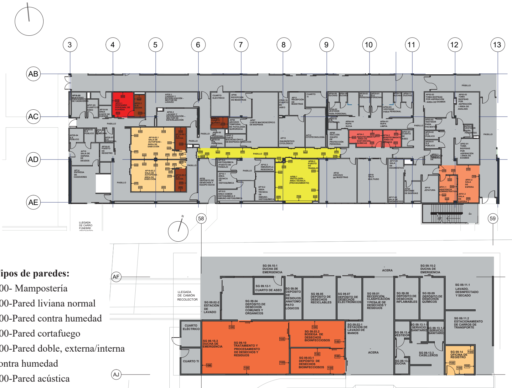
Figura 7.14 Planta de tipos de paredes de los servicios de Acopio y Anatomía Patológica, Fuente: Valverde Vargas, R (2021)
