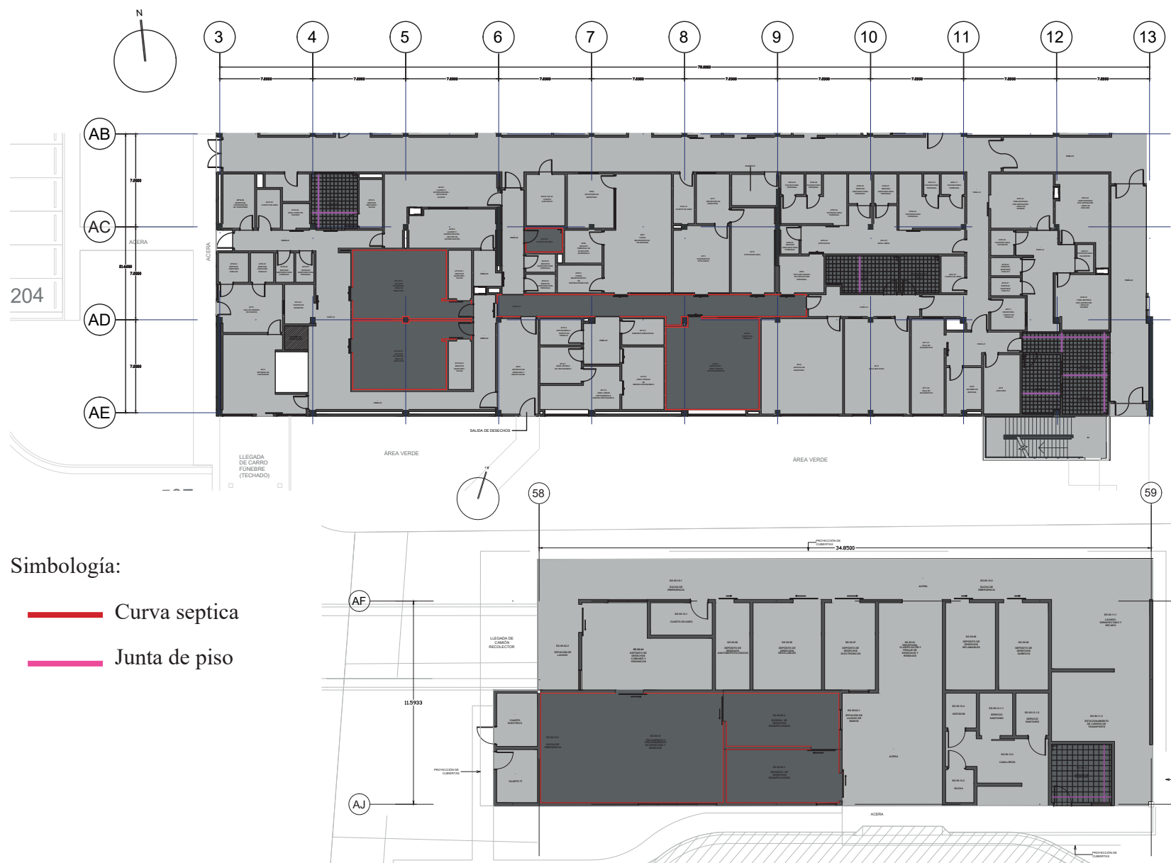
Figura 7.8 Planta de pisos de los servicios de Acopio y Anatomía Patológica, Fuente: Valverde Vargas, R (2021)
