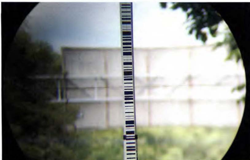
Figura N°42: Lectura a la estadia de códigos de barra Fuente: Propia
