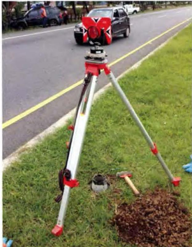
Figura N°23: Aplomo del pin de acero de Hito
