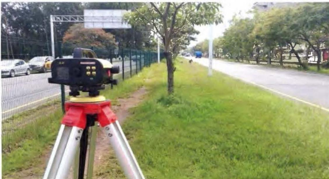
Figura N°41: Nivel Leica® *Sprinter 250*
