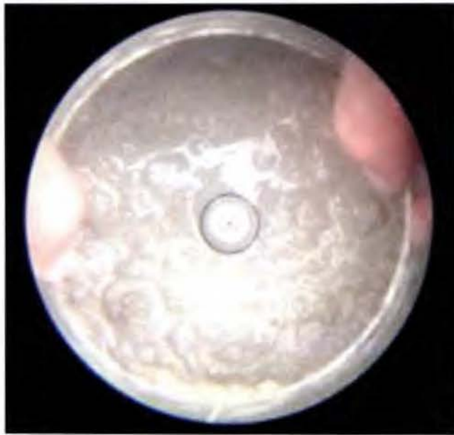
Figura N°24: Pin de acero, centro a plomo Fuente: Propia
