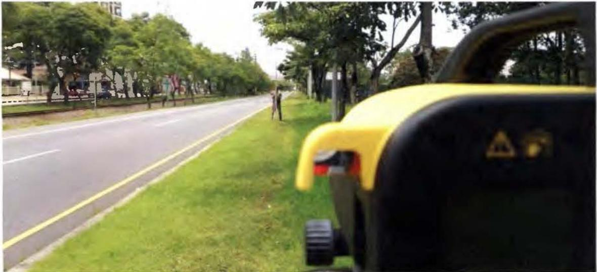
**Figura N°43: Nivelación geométrica**
