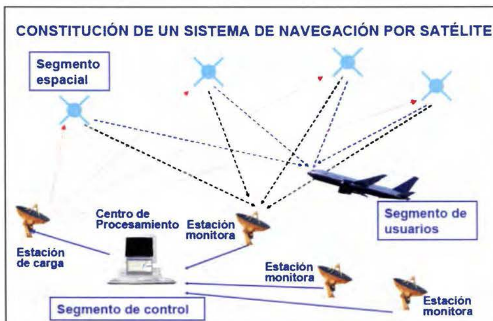
Figura N°6: Funcionamiento de un GNSS
