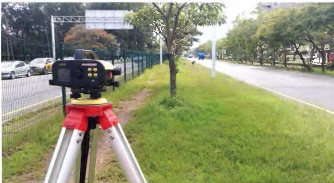
Figura N°41: Nivel Leica® Sprinter 250 Fuente: Propia
