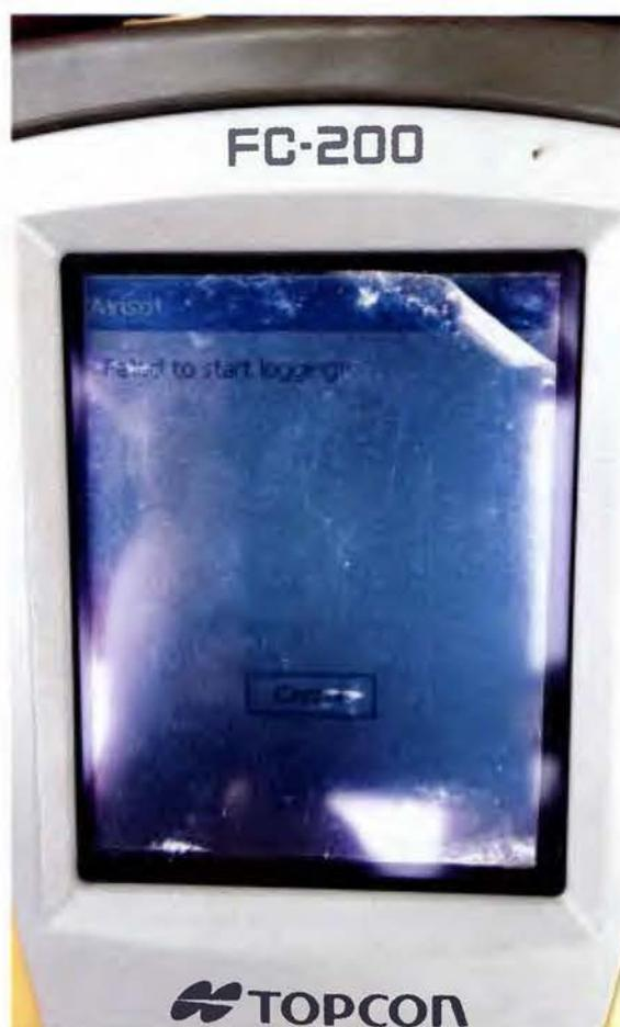
Figura N°32: Error de comunicación colector
