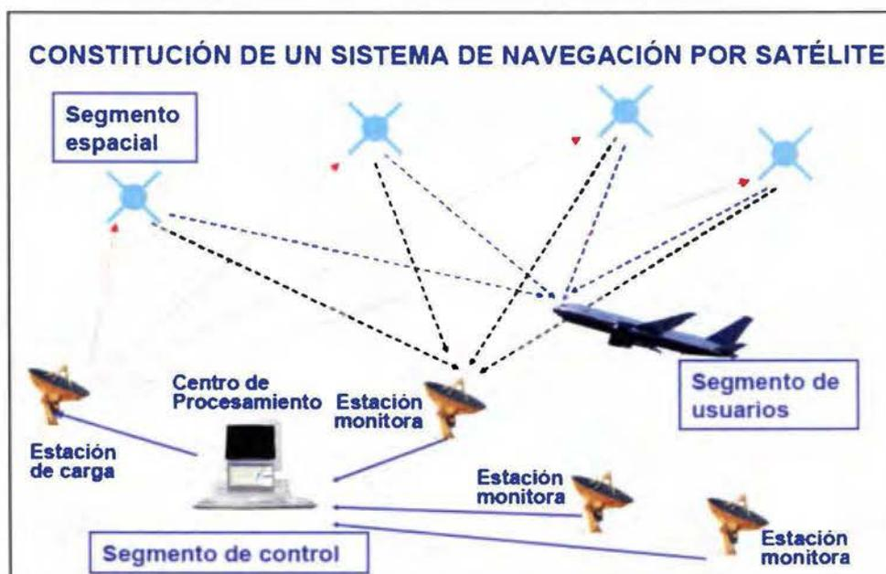
Figura N°6: Funcionamiento de un GNSS
