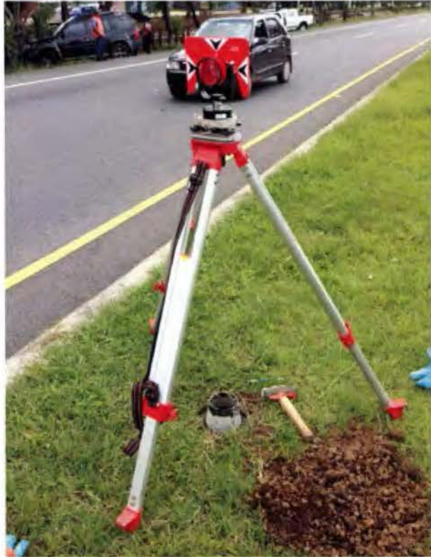
Figura N°23: Aplomo del pin de acero de Hito Fuente: Propia
