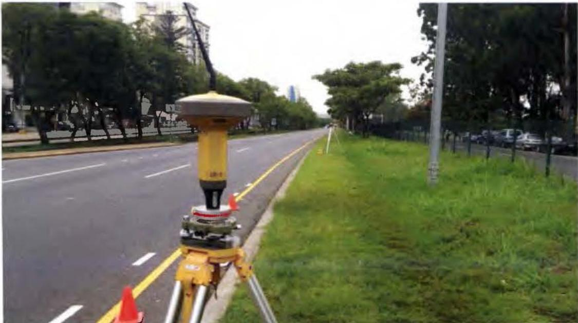
Figura N°34: Receptor GR-3 en Hito N°1
