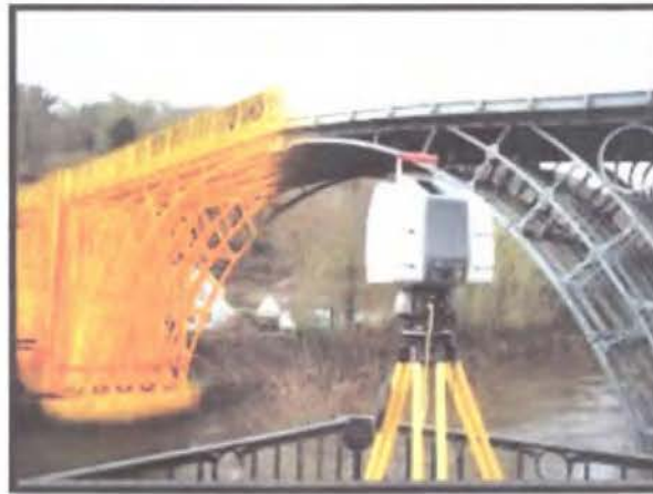
Imagen 10. Levantamiento topográfico con láser escáner (Contreras Echebarria, 2014).
