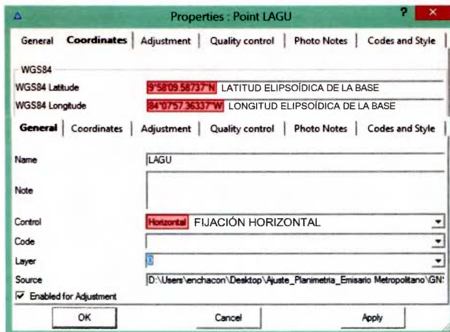
Figura 56. Fijación de bases como puntos de control en el ajuste amarrado.
