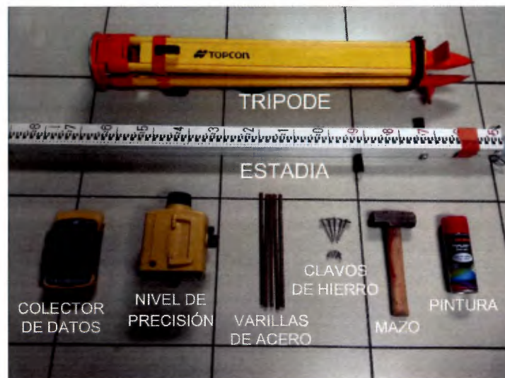
Figura 36. Instrumentación y herramientas para la nivelación diferencial.
