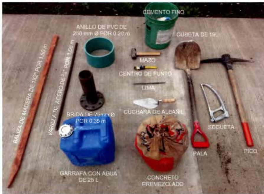
Figura 32. Materiales y herramientas básicas para la monumentación.
