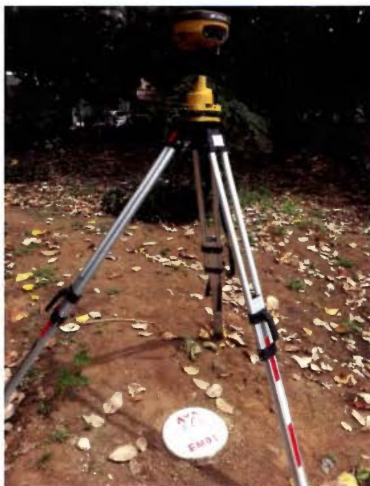
Figura 44. Posicionamiento de un receptor geodésico Topcon Hiper V sobre el mojón EM03.
