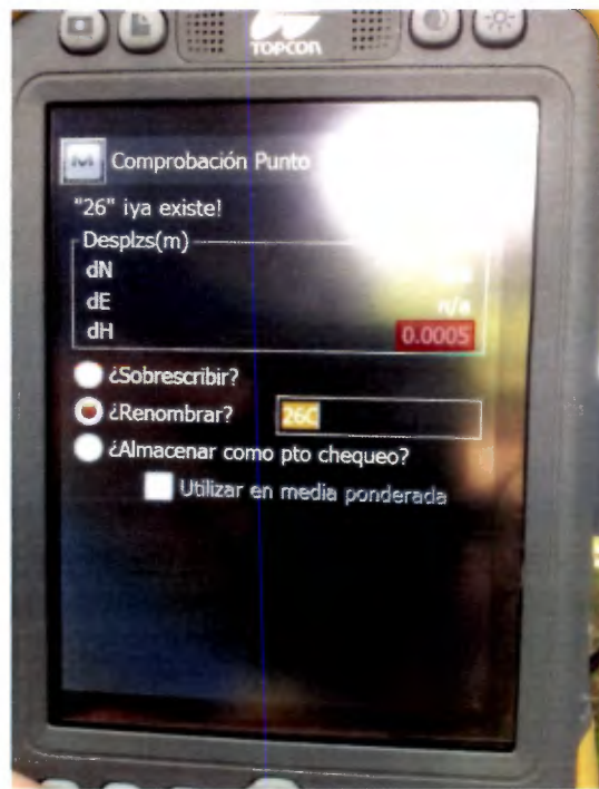
Figura 41. Determinación del error en una nivelación ida y vuelta.
