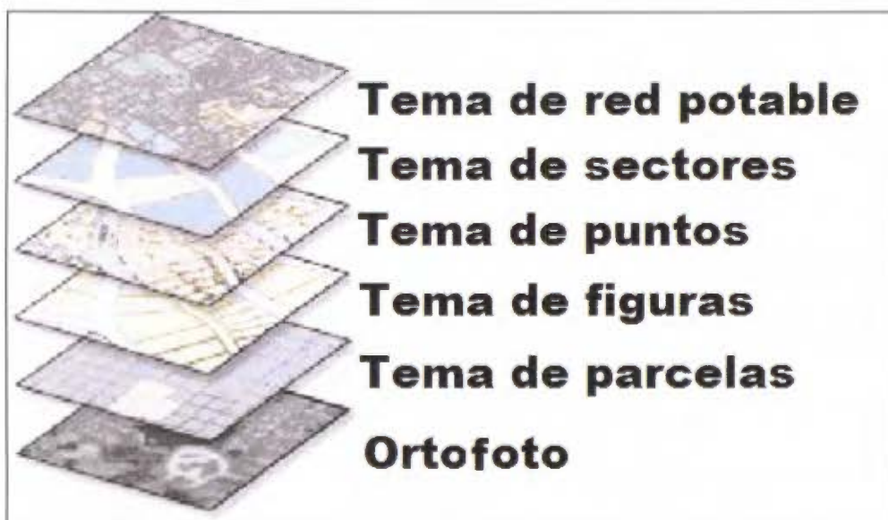
Figura N° 26 Esquema de temas en formato .shp para resguardo de información en SIG Fuente: Municipalidad de San José/ Editado por: Elaboración propia
