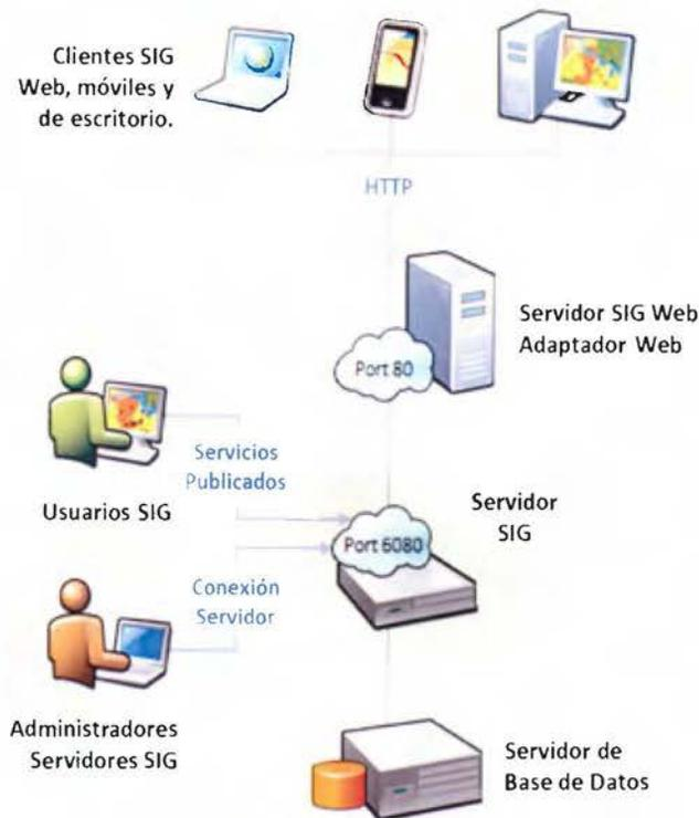
**Figura 10.** Arquitectura Servidor – Cliente de un SIG Web, donde el servidor se comunica con el cliente mediante tecnología HTTP. Fuente: Fu, P., & Sun, J. (2010). Web GIS: Principles and Applications.
