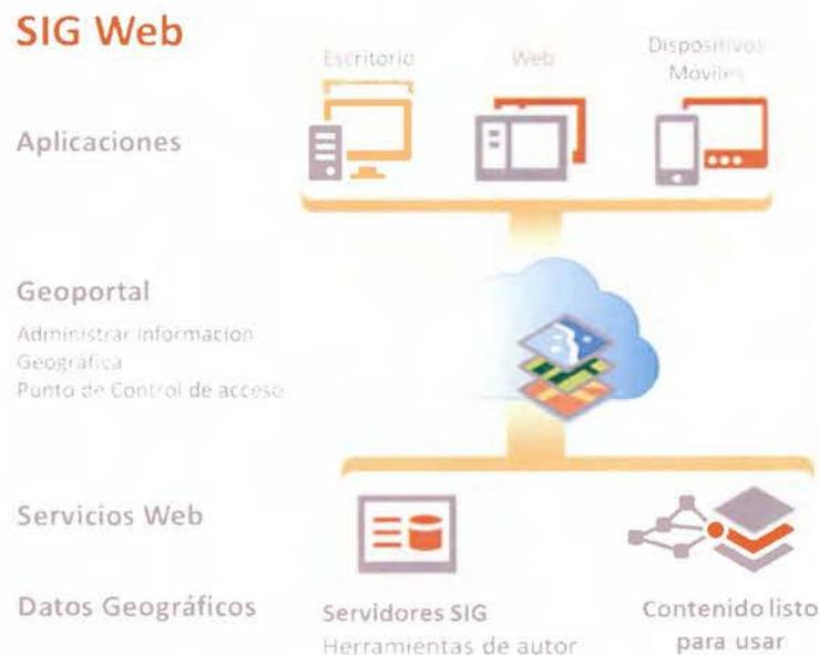
**Figura 11.** Estructura conceptual de un SIG Web. Fuente: Fu, P., & Sun, J. (2010). Web GIS: Principles and Applications.
