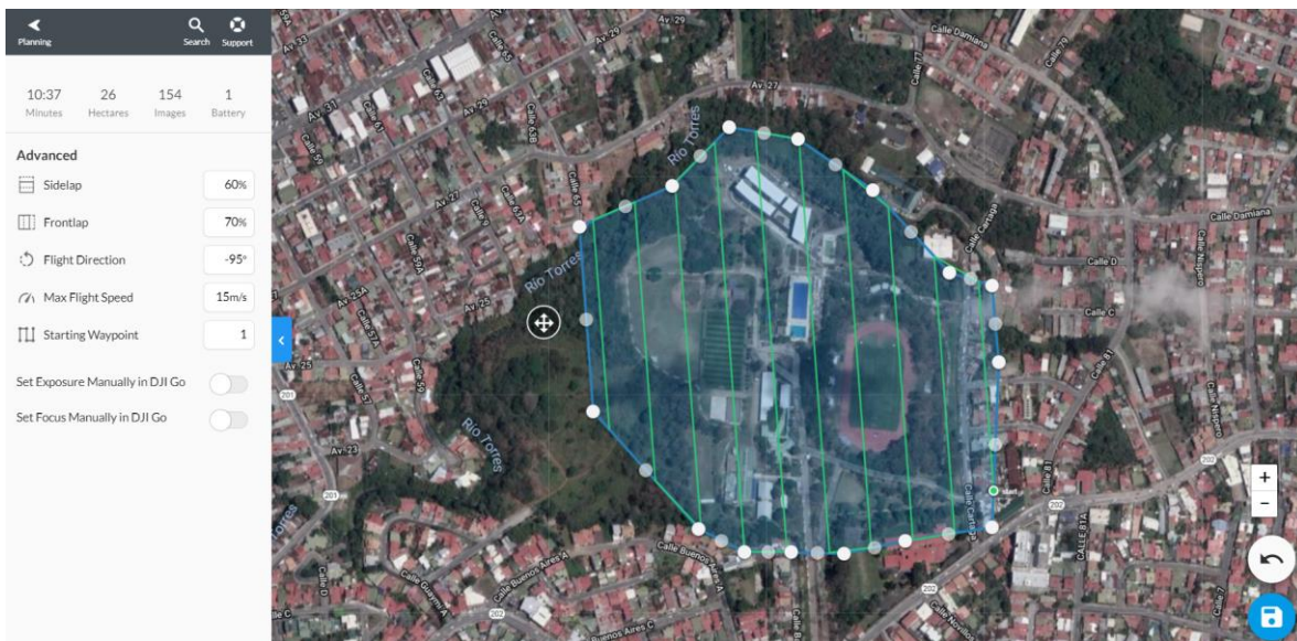
Figura 28. Diseño de Plan de Vuelo en software DroneDeploy. Fuente: DroneDeploy- Elaboración Propia, 2018.
