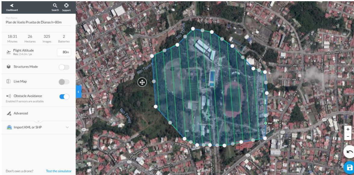
Figura 27. Diseño de Plan de Vuelo en software DroneDeploy. Fuente: DroneDeploy- Elaboración Propia, 2018.
