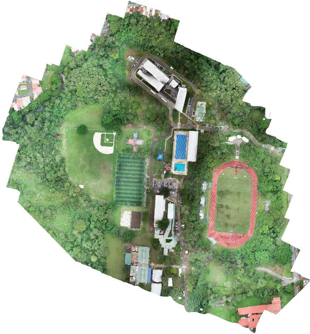
Figura 32. Ortofoto obtenida del procesamiento en el software de ajuste fotogramétrico. Fuente: Elaboración propia, 2018.
