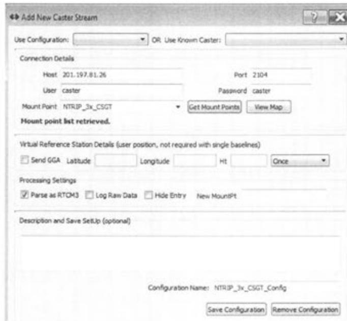
Figura 16. Estación de Geotecnologías, Mountpoint NTRIP\_3x\_CSGT en el caster experimental. Fuente software SNIP®.
