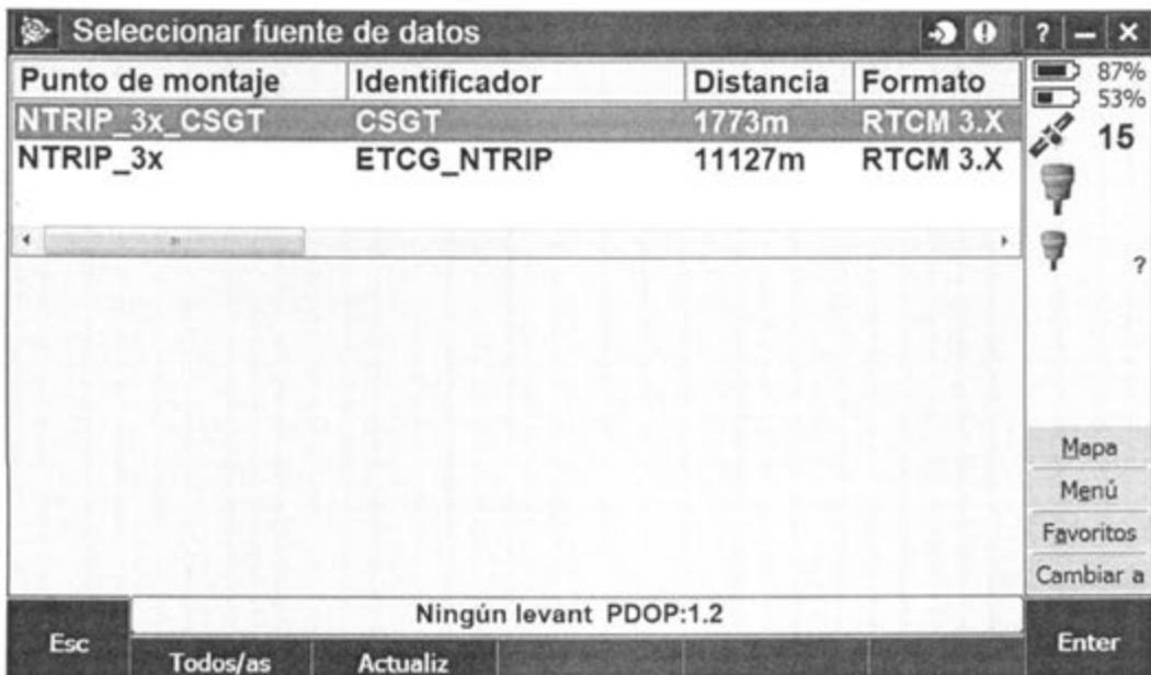
Figura 6. Mountpoints utilizados como parte del NTRIPSource.
