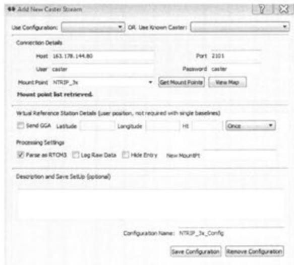
Figura 15. Estación ETCG. Mountpoint NTRIP\_3x en el caster experimental.
