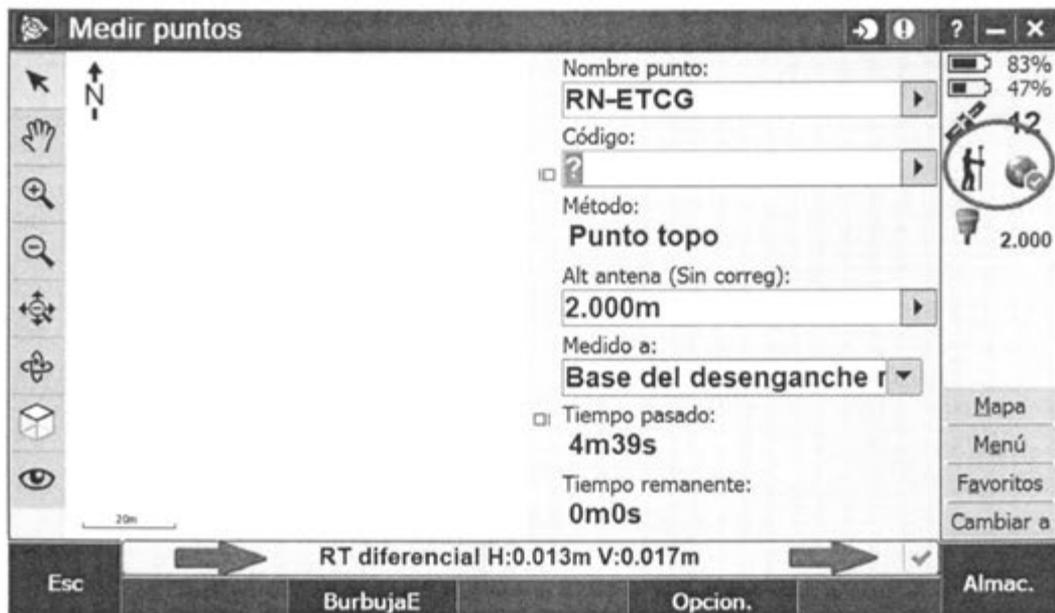
Figura 44. Levantamiento en tiempo real, se aprecia exactitudes del equipo receptor.
