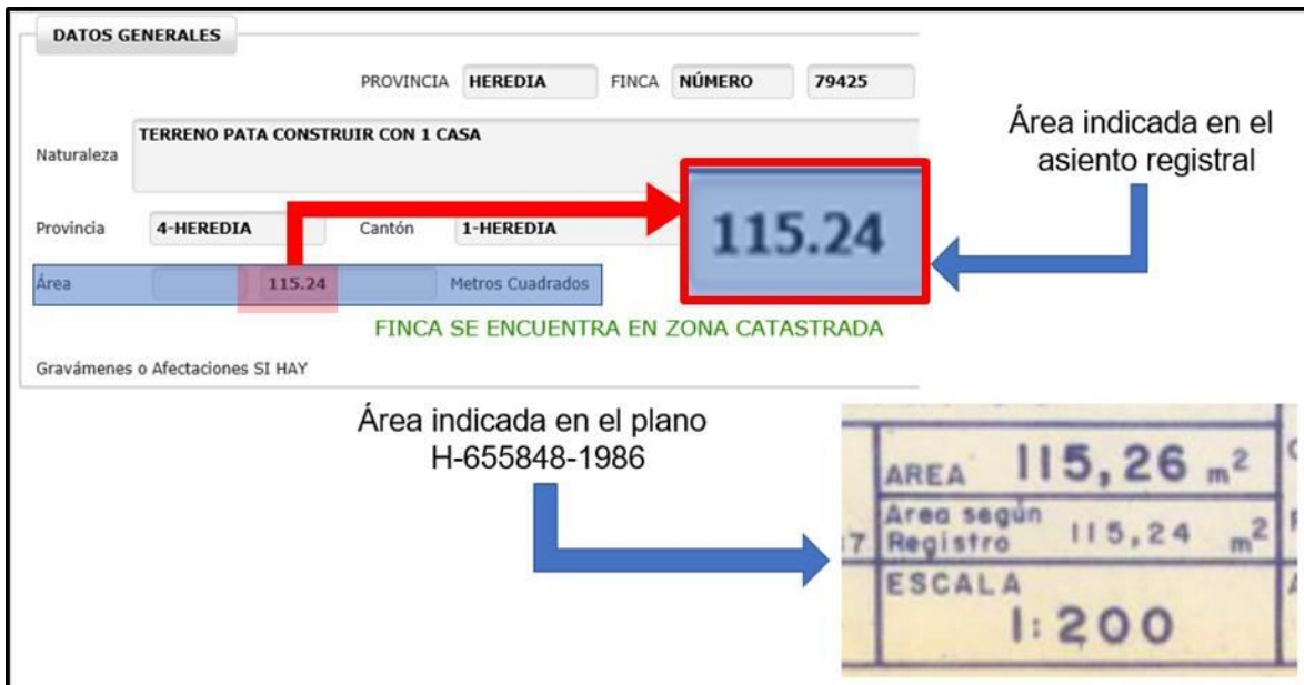
Figura 94. Área mostrada en el asiento registral de la finca 4-76425 respecto a la indicada en el plano H-655848-1986. Tomado del SIRE y del SIP
