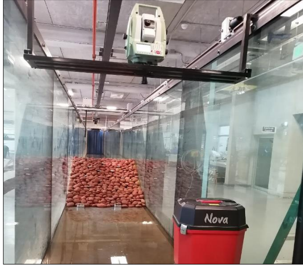
Figura 18. Estructura metálica para estacionamiento de MS50.
