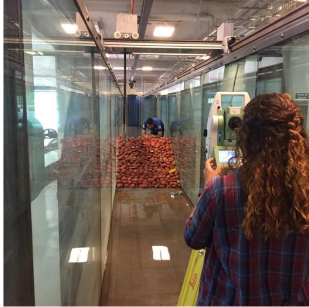
Figura 14. Medición de placas de control con estación total Leica Viva TS11.
