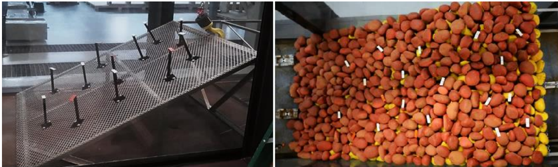
Figura 22. Montaje de modelo físico final y placas de control arbitrario de color blanco, dentro del canal de oleaje. Vista en perspectiva y vista en planta.
