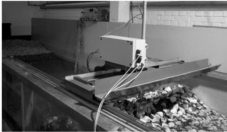
Figura 2. Perfilador láser en canal de oleaje.
