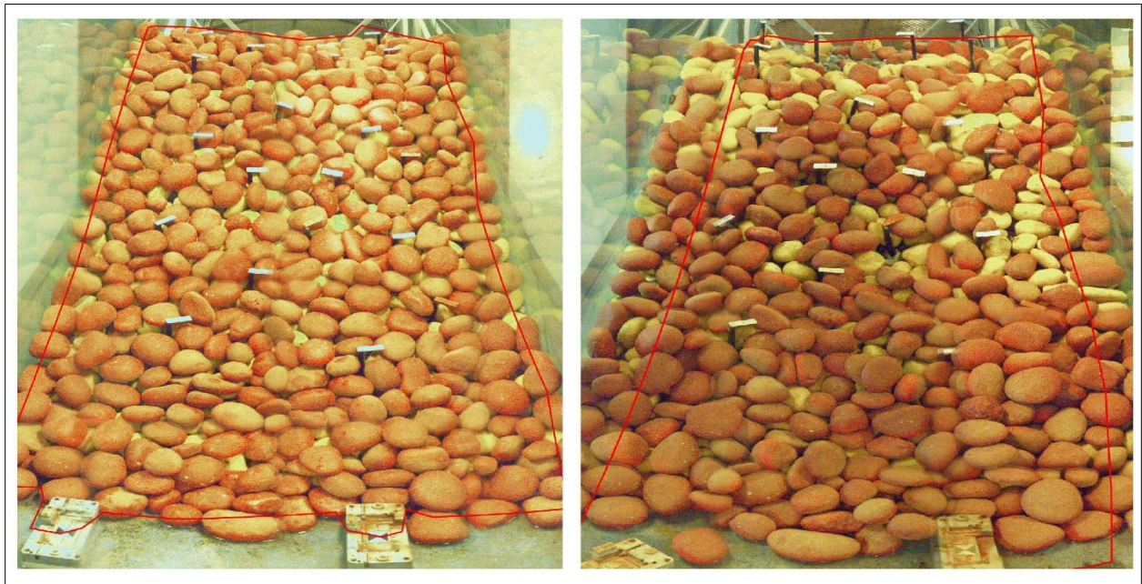
Figura 46. Imágenes de modelo físico capturado por la cámara incorporada de MS50. Polígono escogido como zona de escaneo en ambas épocas de medición.
