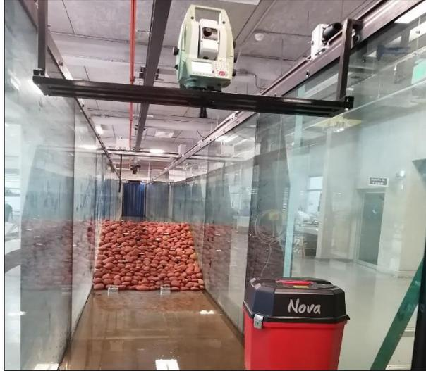
**Figura 18.** Estructura metálica para estacionamiento de MS50.
