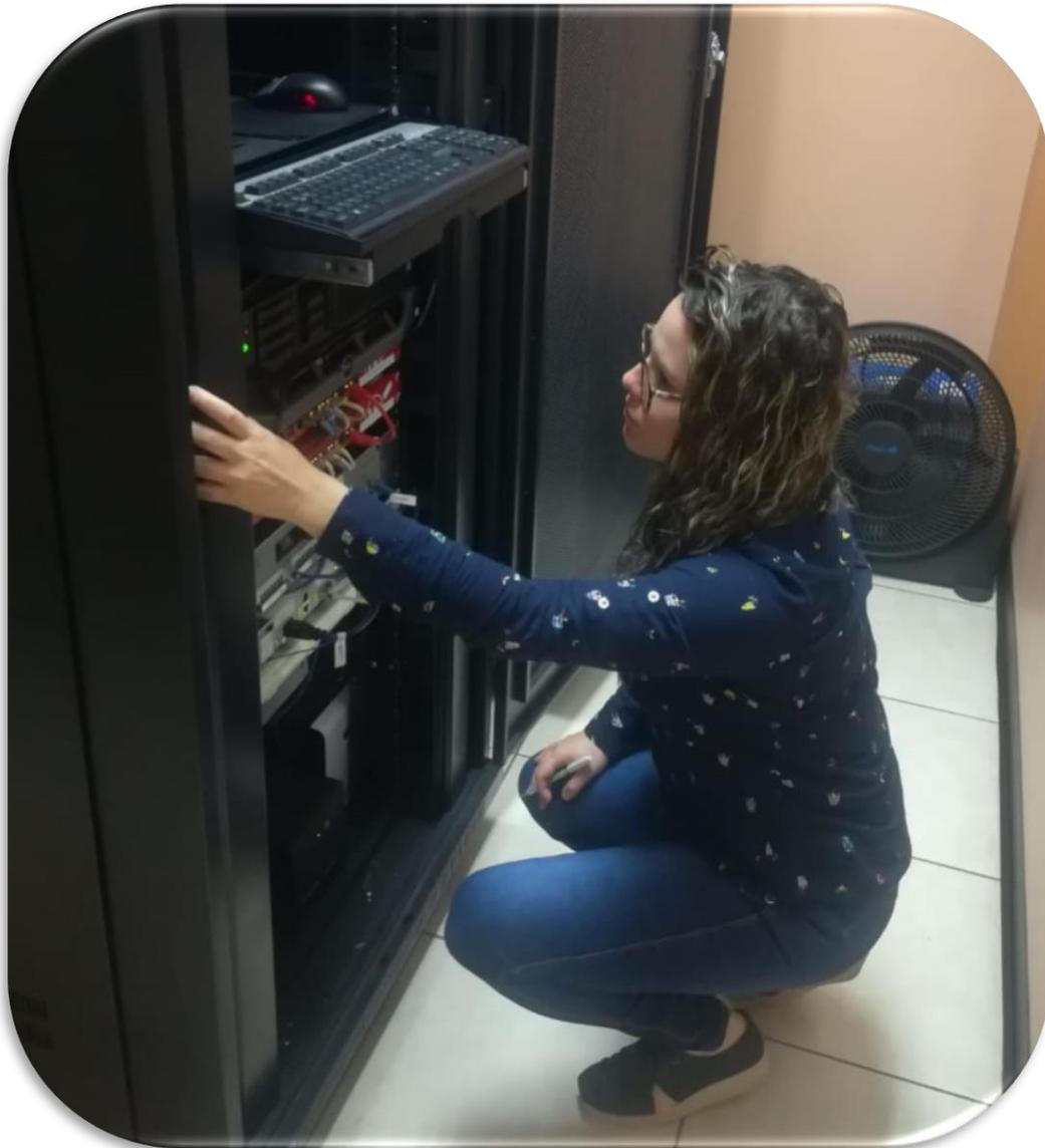
Fotografía 2. Servidor HP ProLiant DL380 G6 Server, instalado en el rack y conectado a la red de la Municipalidad de Alajuelita.
