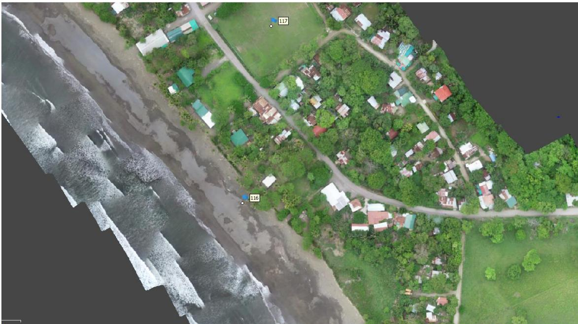
Figura 9: Vista del Ortomosaico. Resolución de 5 cm/pix.
