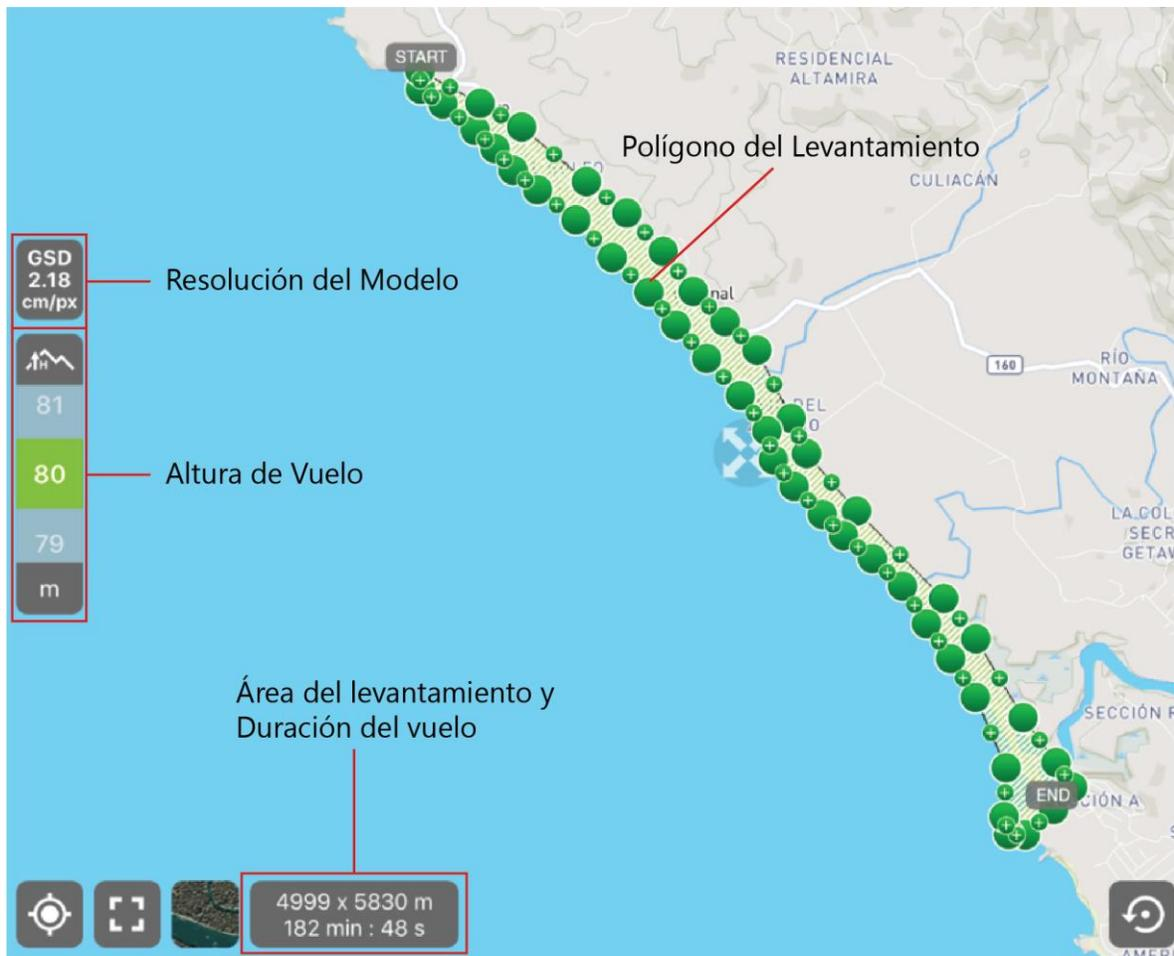
Figura 4: Vista del menú del planeamiento de vuelo de la aplicación Pix4D.
