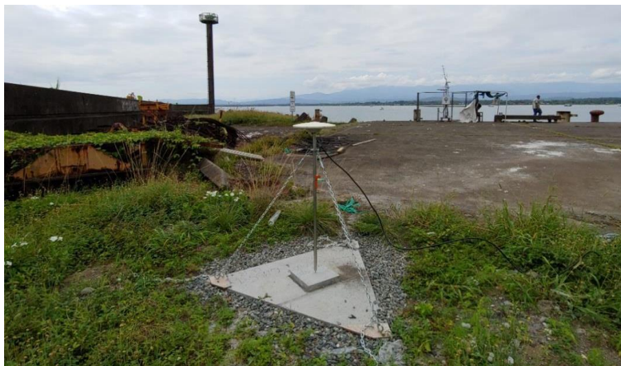
Figura 13. Medición con GNSS del punto fundamental, BM.Limón, en Limón. Fuente: Propia, 2020.
