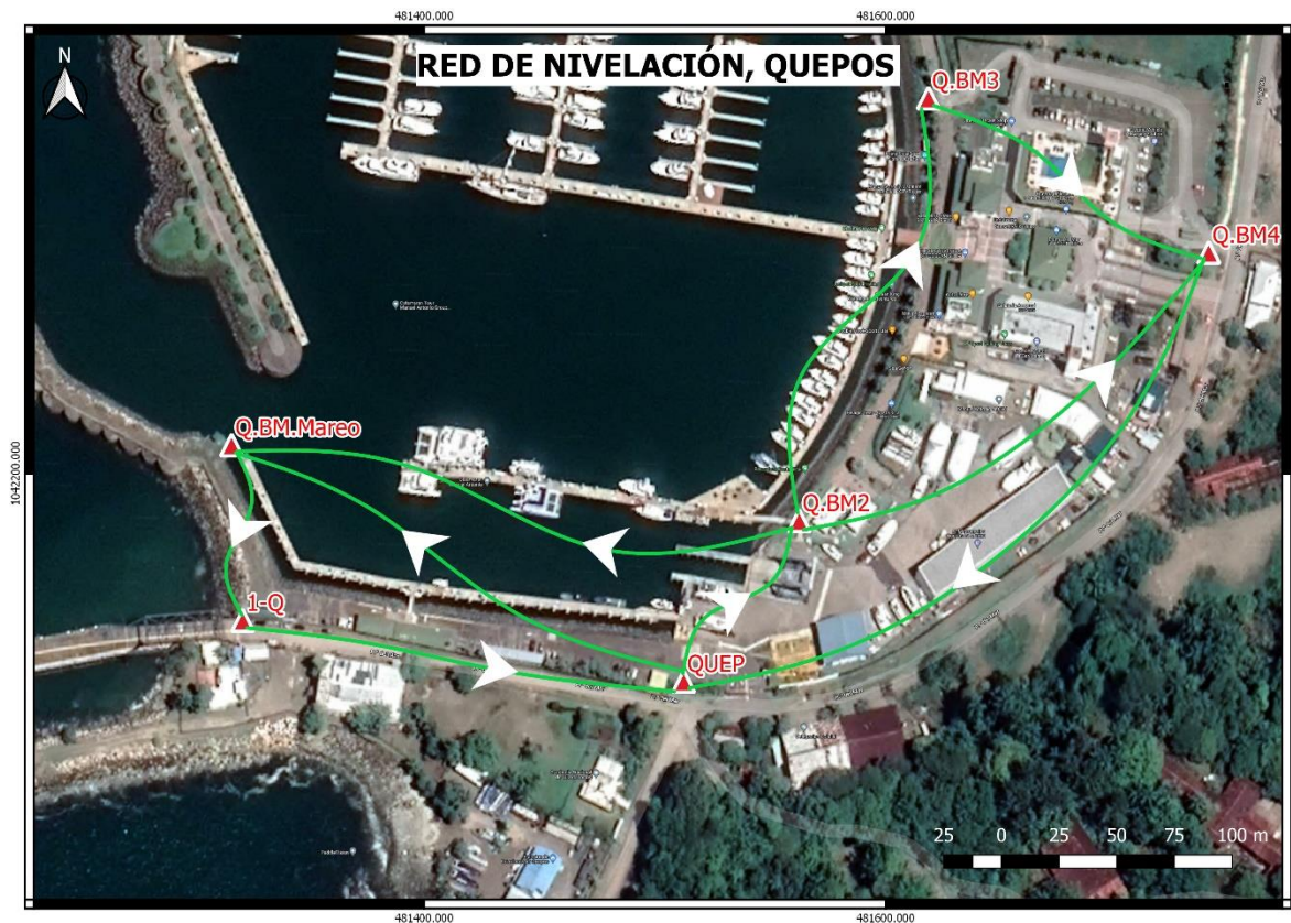
Figura 11. Líneas de nivelación en Quepos. Fuente: Propia, 2021.
