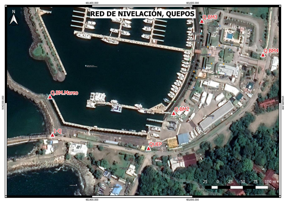
Figura 6. Puntos para los circuitos de nivelación y medición de GNSS en Quepos, creado con 3 bancos de nivel, 1 de la red del IGN y un punto del mareógrafo. Fuente propia, 2021.
