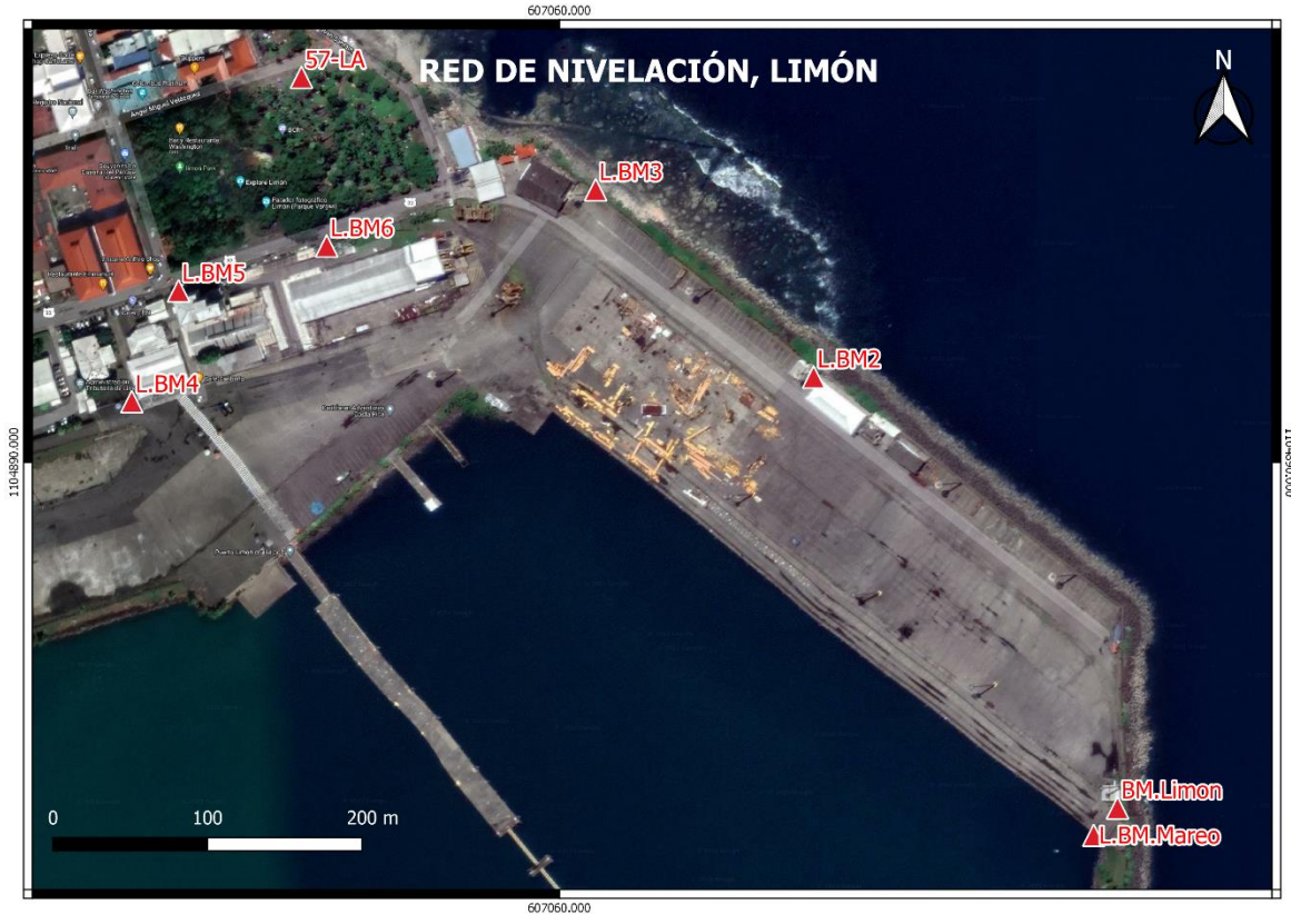
Figura 9. Puntos para los circuitos de nivelación y medición de GNSS Limón, creado con 6 bancos de nivel, 1 de la red del IGN y un punto del mareógrafo. Fuente propia, 2021.
