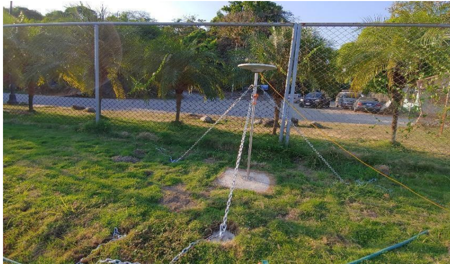
Figura 14. Medición con GNSS del punto fundamental, QUEP, en Quepos. Fuente: Propia, 2020.
