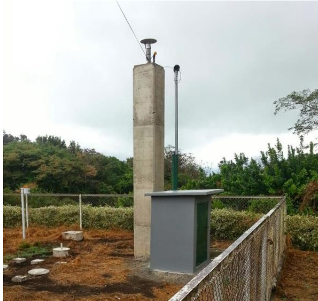
Figura 3.3. Estación de referencia del ICE, ubicado en Tronadora, Guanacaste. Fuente: Instituto Costarricense de Electricidad, Área de Topografía (2021).
