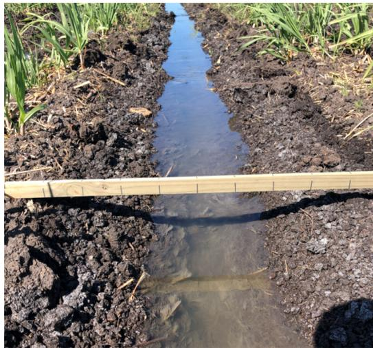
**Figura 9. Medición de sección transversal, parcela I8.**
