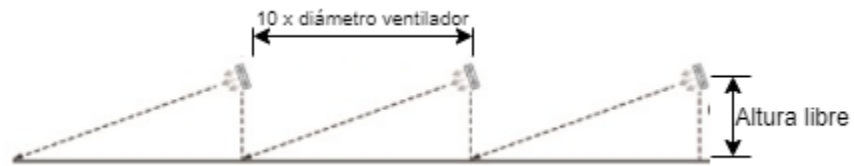
Figura 15. Distancia recomendada entre ventiladores [70]
