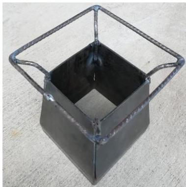
(c) Fijación del quemador.
