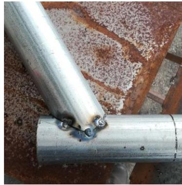
(f) Unión por puntos de soldadura.
