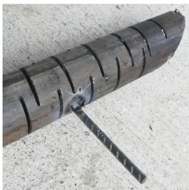
(b) Fijación de varilla al tubo perforado.
