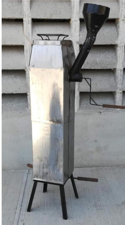
**Figura 4.19.** Estufa gasificada construida.
