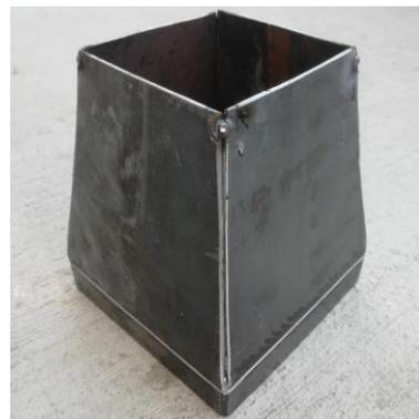
(d) Unión de las paredes inclinadas.
