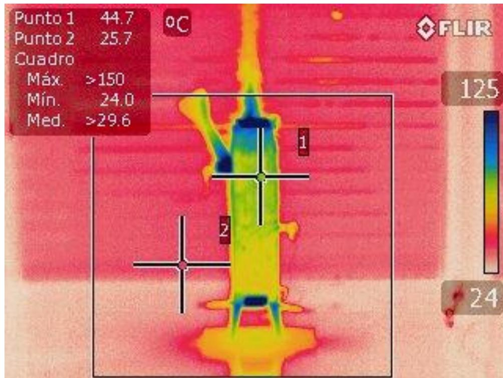
**Figura 4.29.** Imagen térmica de la estufa gasificada en operación.
