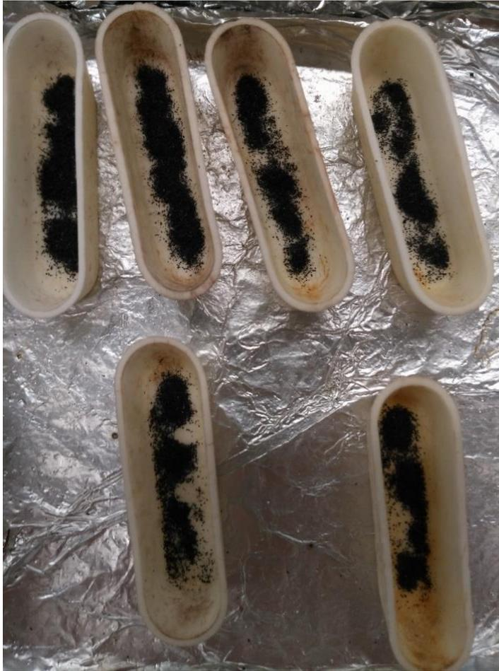
Figura 5.3. Muestras de biochar para TOC en botes de cerámica
