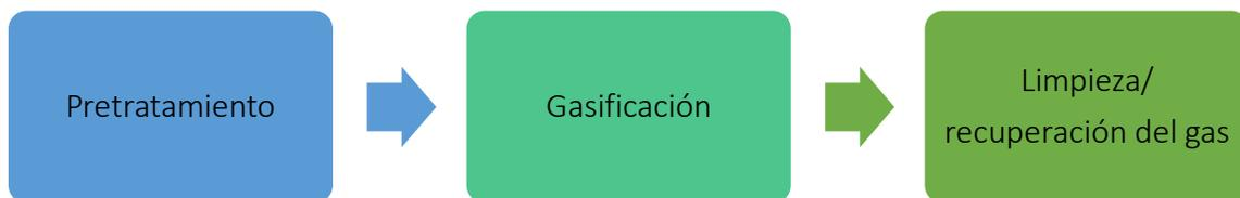
**Figura 7.12.** Etapas para un sistema de gasificación
