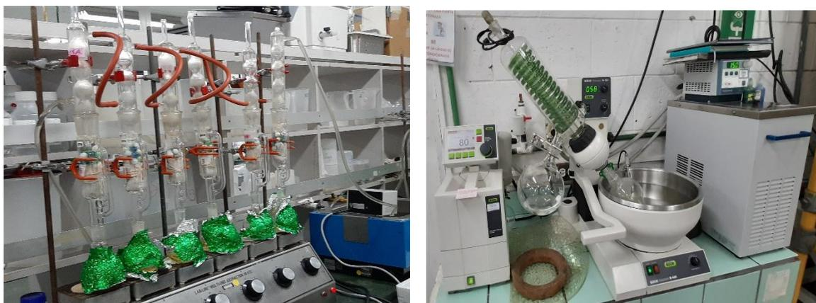
**Figura 6.4.** Equipos soxhlet y rotavapor utilizados en la determinación de extractos.
