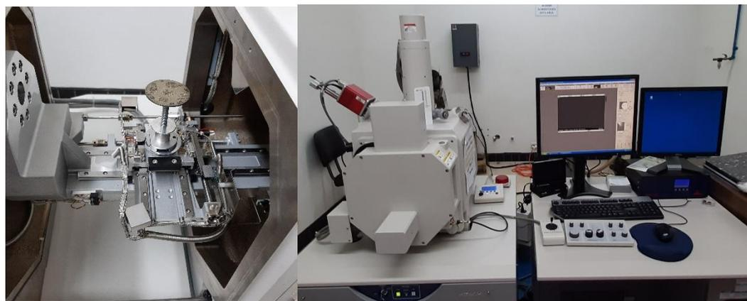
**Figura 6.6.** Microscopio electrónico de barrido, CIEMic.
