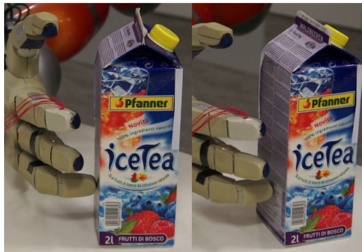
Figura 2.16: TUM-Rosie manipulando una caja mediante un modelo del objeto
