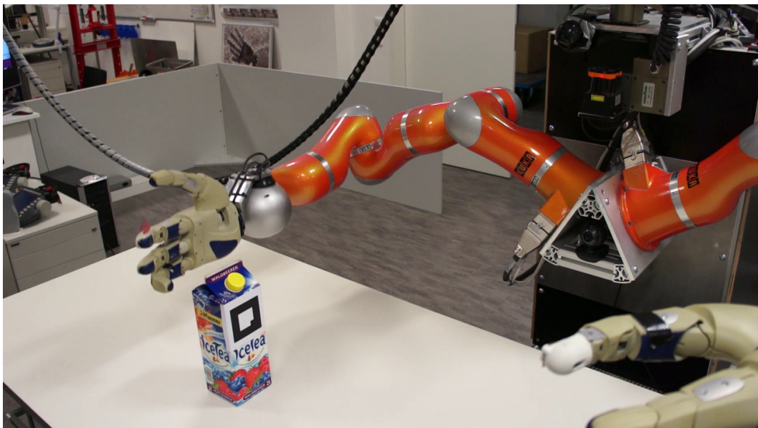
Figura 2.3: Robot TUM-Rosie acercándose a un objeto con el fin de manipularlo
