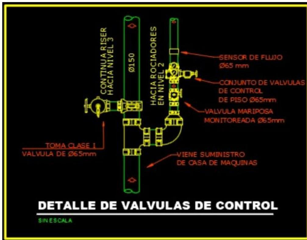
ILUSTRACIÓN XII: DETALLES DE VÁLVULAS DE CONTROL.
