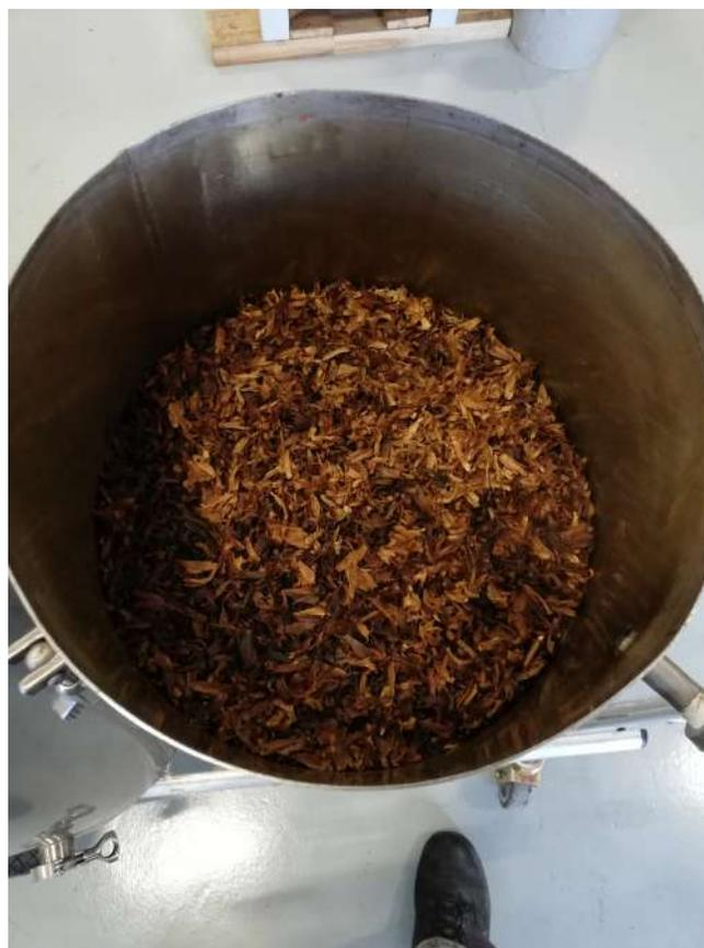
Figura 4.20: Burucha con alquitran del primer filtro de barrera.
