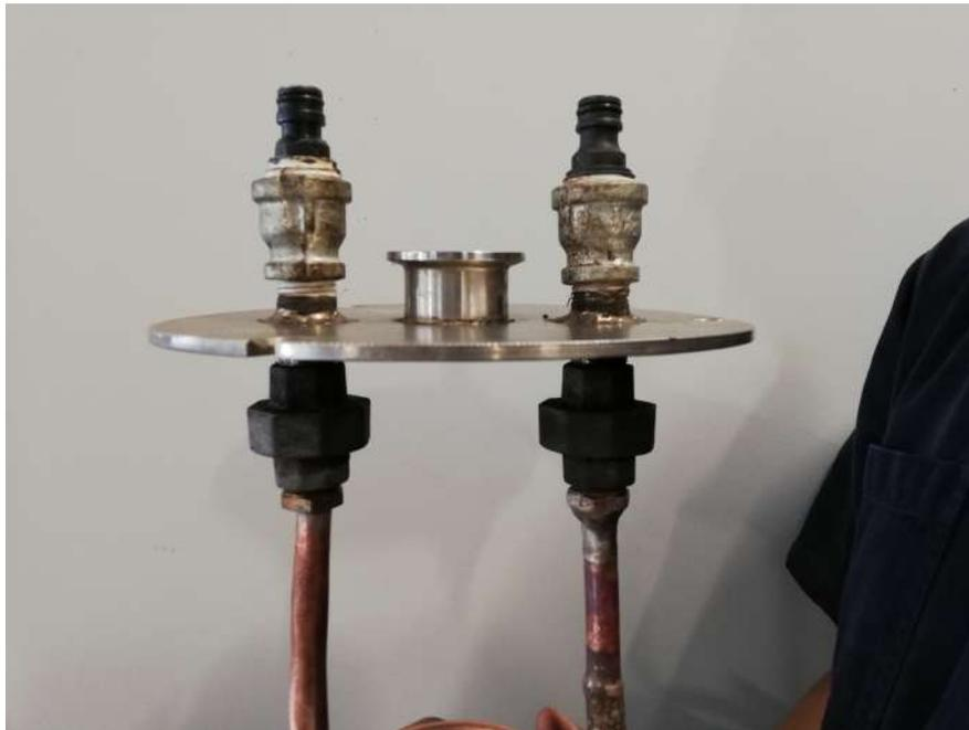
Figura 4.4: Tapa del intercambiador de calor.
