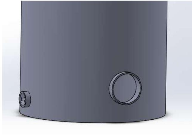
Figura 4.2: Modelo de la parte inferior de la carcasa del intercambiador de calor.
