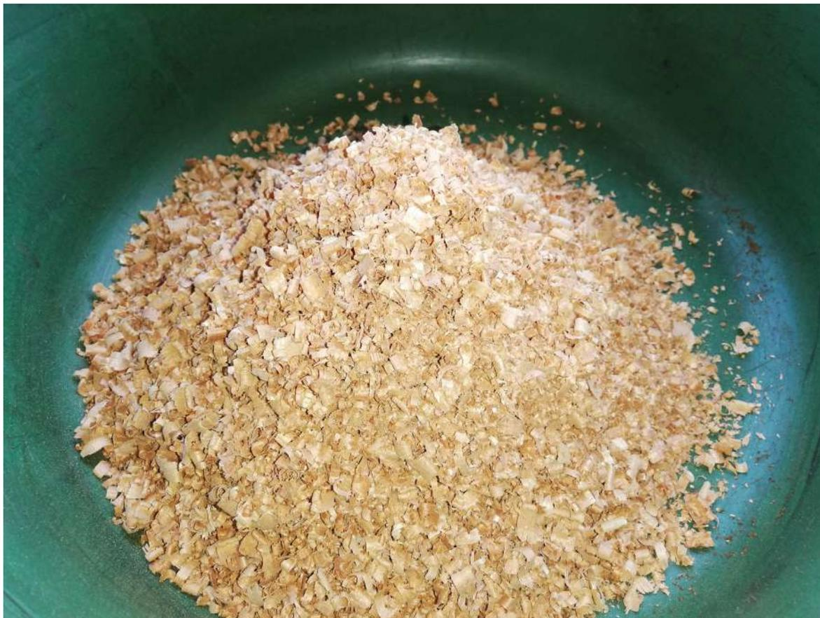
Figura 4.6: Burucha utilizada para el primer filtro de barrera.
