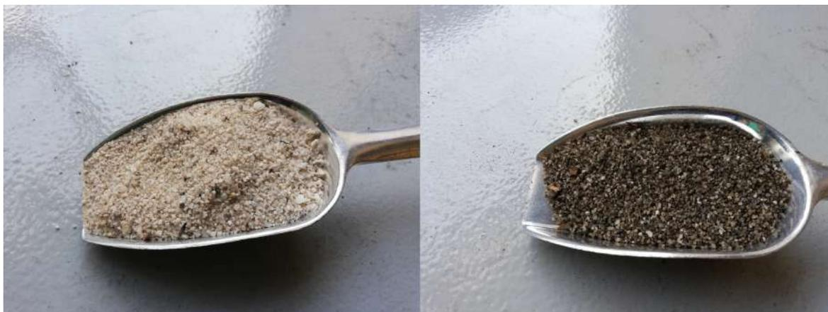
Figura 4.21: Arena sílica antes y después una corrida del reactor.
