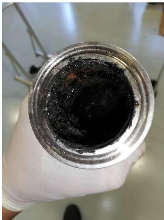
Figura 4.17: Interior del contenedor de partículas del ciclón (sucio).
