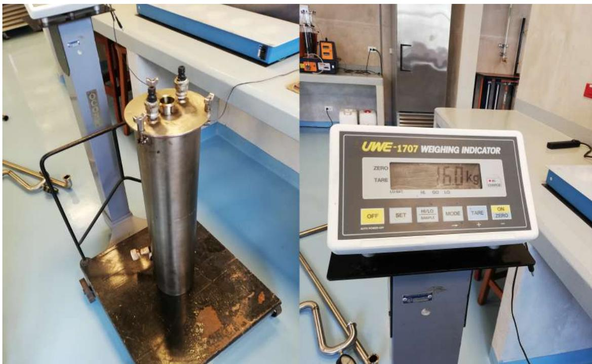
Figura 4.10: Medida de la masa del intercambiador de calor.
