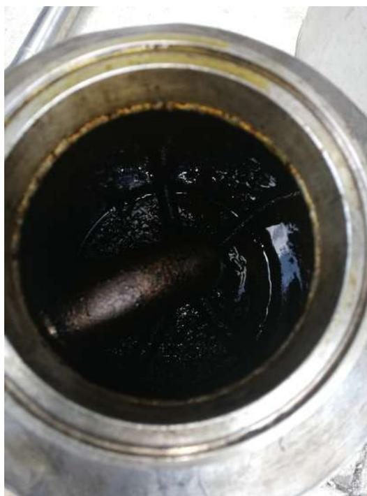
Figura 4.18: Interior del burbujeador (sucio).
