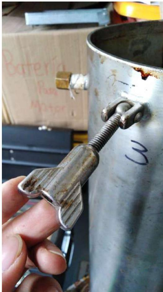
Figura 4.3: Piezas de sujeción entre la tapa y la carcasa.
