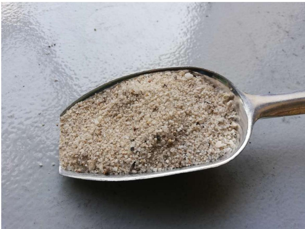
Figura 4.7: Arena sílica utilizada para el segundo filtro de barrera.
