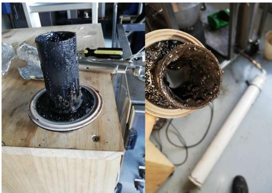
Figura 4.16: Tapa y conducto de salida del ciclón (sucio).
