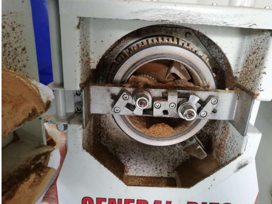
Figura 4.1: Estructura interna de la peletizadora.
