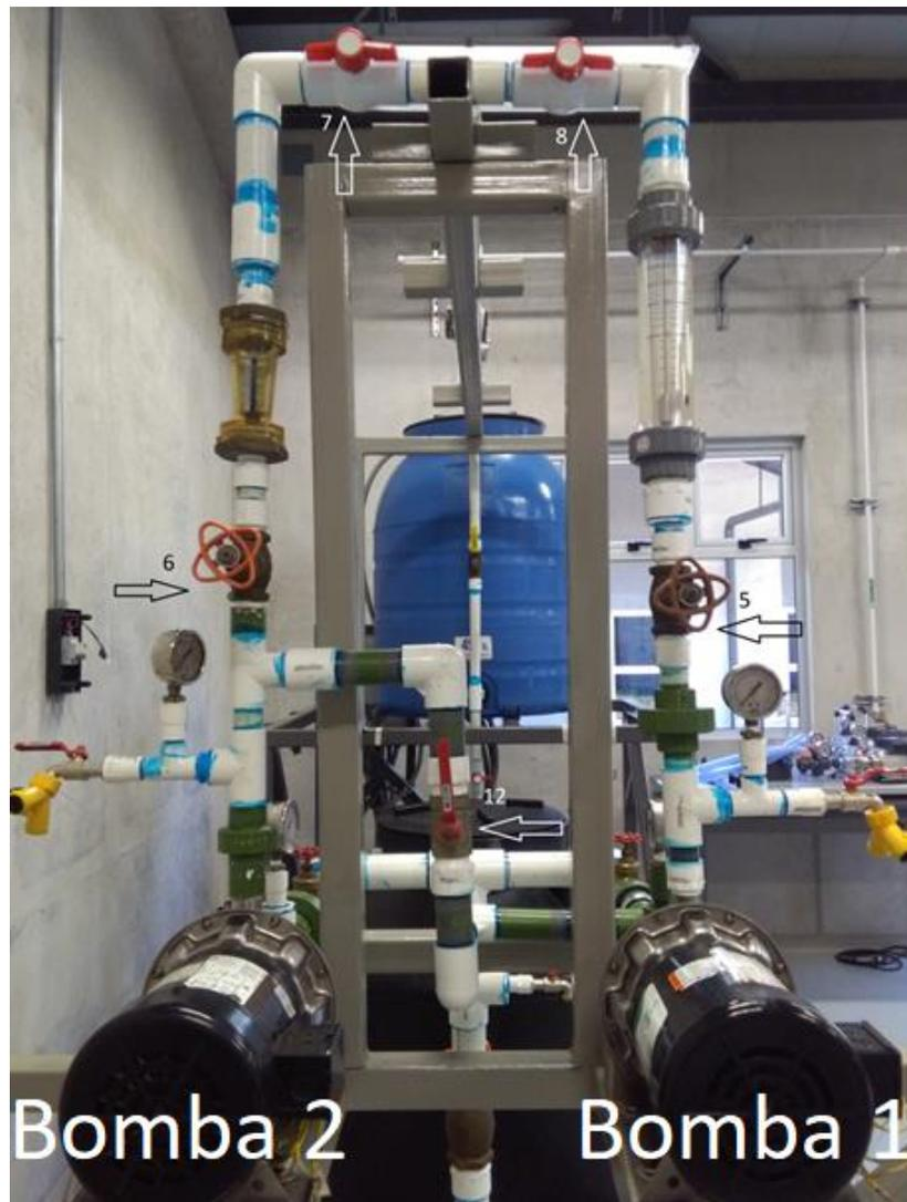
Figura 4.7: Sistema de válvulas. (Fuente propia).
