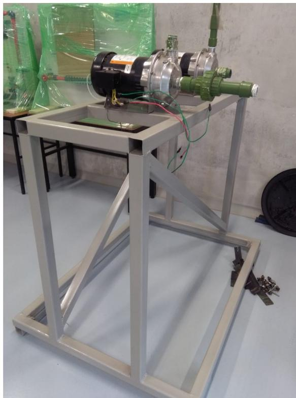
Figura 4.3: Base para bombas centrífugas. (Fuente propia).
