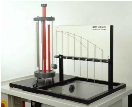
Figura 3.7: Descarga horizontal por orificios. (Fuente: Gunt Hamburg, 2016).
