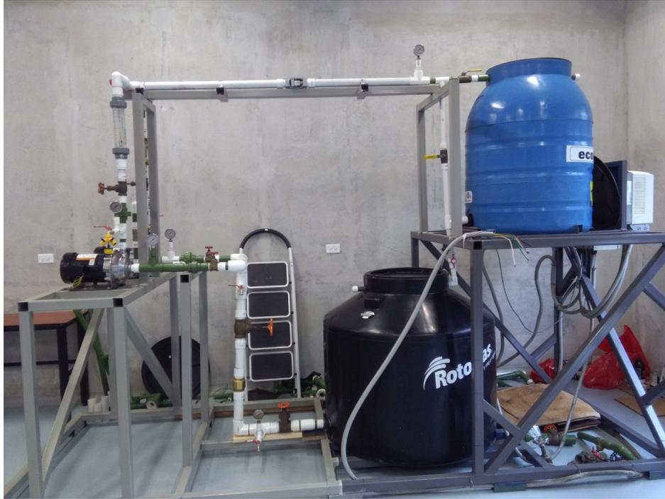
Figura 4.5: Soportería del sistema. (Fuente propia).
