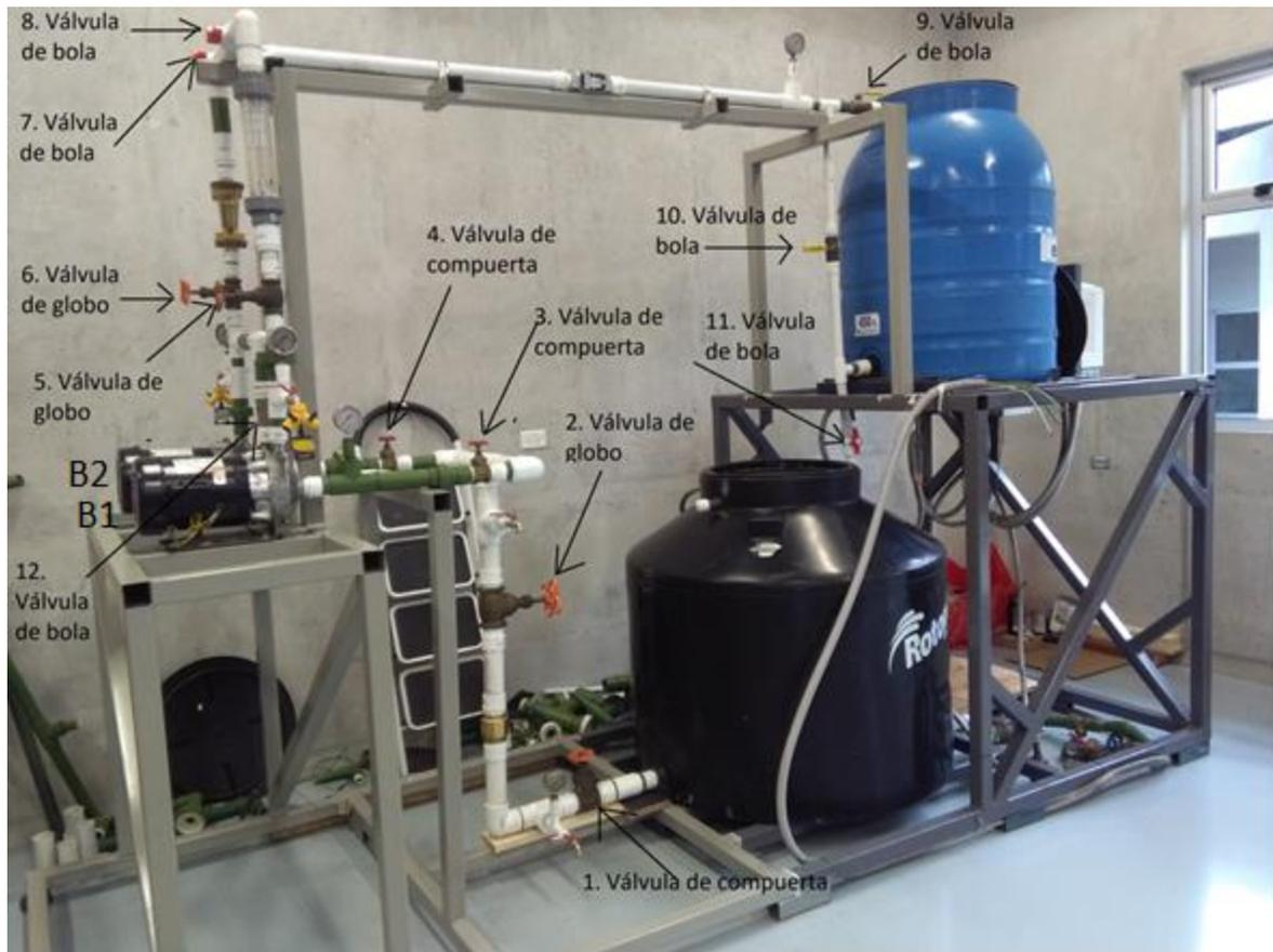
Figura 4.6: Sistema de válvulas. (Fuente propia).
