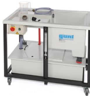
Figura 5.5: Módulo básico, HM 150. Fuente: Gunt Hamburg.
