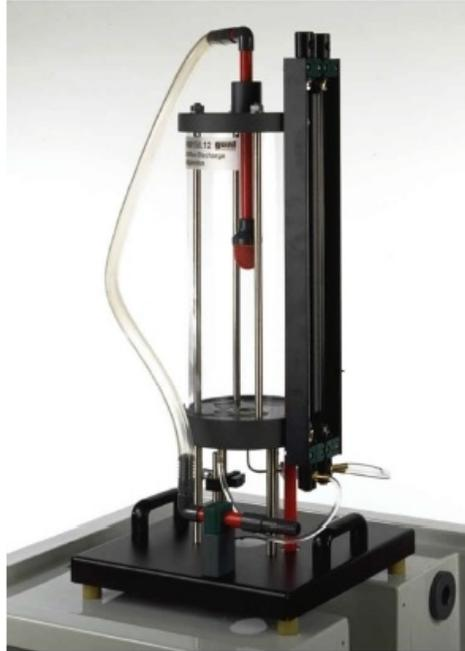
Figura 3.8: Descarga vertical por orificios. (Fuente: Gunt Hamburg, 2016).
