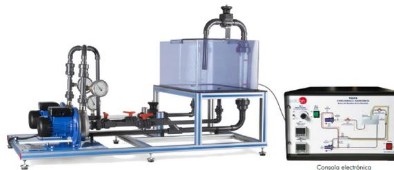
Figura 3.18: Banco de bombas en serie y paralelo. (Fuente: Edibon, 2017).
