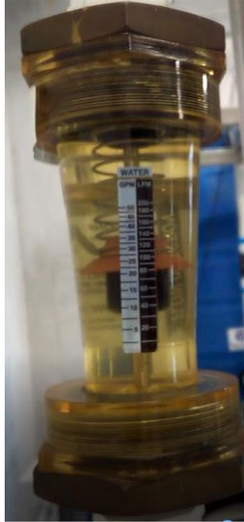
Figura 2.22: Imagen del flujómetro de resorte opuesto. (Fuente propia).
