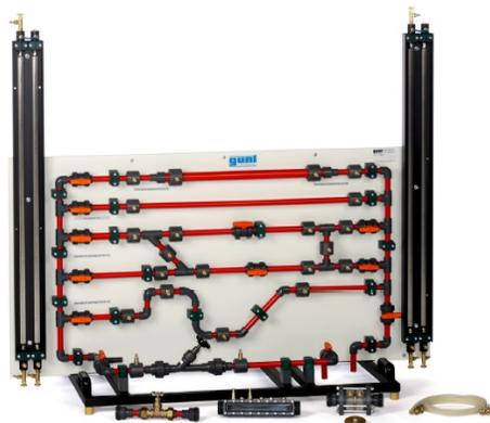
Figura 3.9: Pérdidas en tuberías. (Fuente: Gunt Hamburg, 2016).
