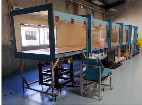
Figura 3.12: Tunel de viento. (Fuente: Propia, 2021).
