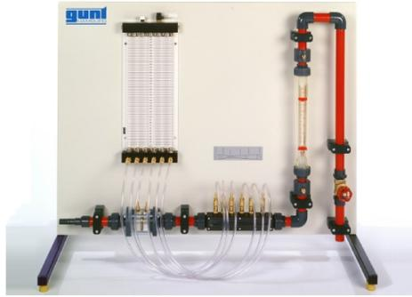
Figura 3.10: Medición de caudal. (Fuente: Gunt Hamburg, 2016).
