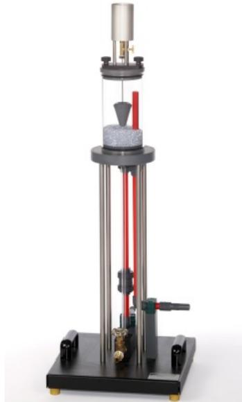
Figura 3.11: Ensayo de Osborne Reynolds. (Fuente: Gunt Hamburg, 2016).
