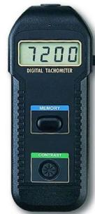
Figura 5.7: Tacómetro. Fuente: Gunt Hamburg.
