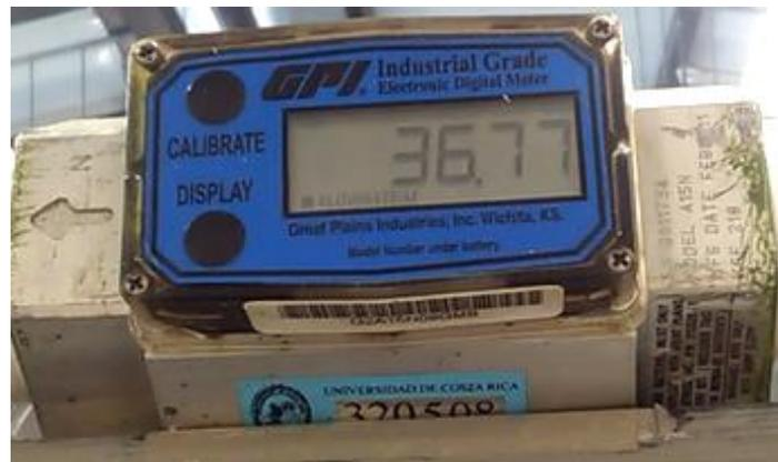
Figura 2.23: Imagen del flujómetro de tipo turbina. (Fuente propia).
