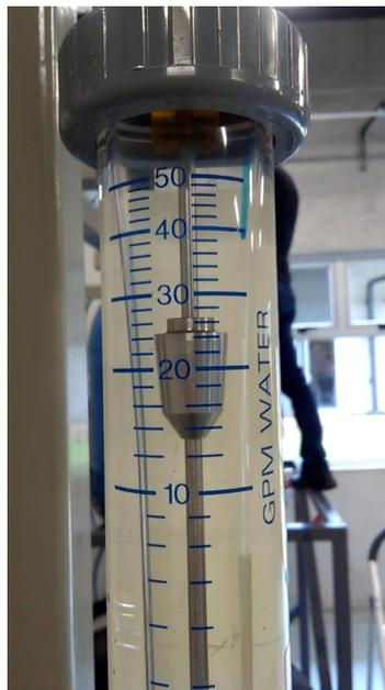
Figura 2.21: Imagen del flujómetro de tipo rotámetro. (Fuente propia).
