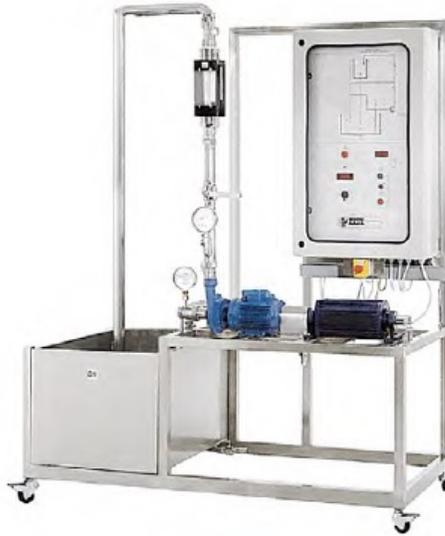
Figura 3.20: Banco de prueba de bombas centrífugas. (Fuente: Veneta, 2022).
