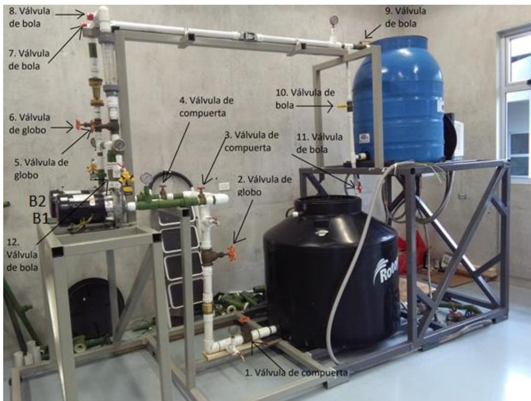
Figura 5.9: Sistema de válvulas. Fuente: Propia.
