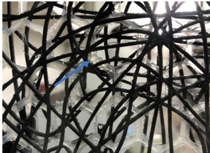
Figura 4.20. Gotas de agua en la capa hexagonal de malla ASA
