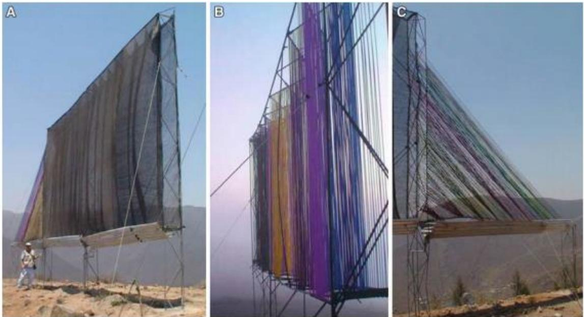
Figura 2.3. Pruebas piloto de nuevos diseños de colectores. a) Colector Eiffel. b) Colector de arpa. c) Colector de arpa diagonal. Fuente: Domen, *et.al.* 2013
