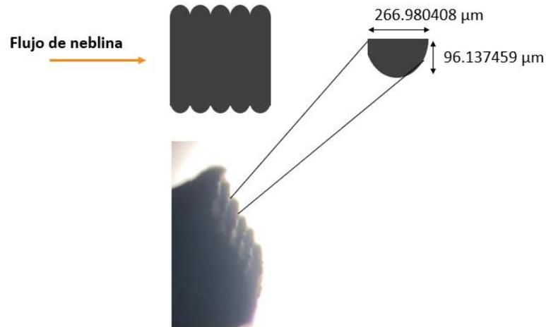
Figura 4.14. Perfil en capa de ABS con fibra de carbono (Fotos tomadas con Microscopio Óptico, Marca Motic, Modelo B410). Fuente: Elaboración Propia
