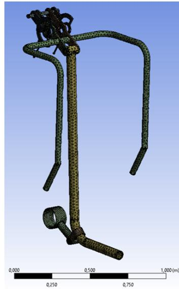
Figura 7.8: Modelo con el mallado realizado (Elaboración propia)
