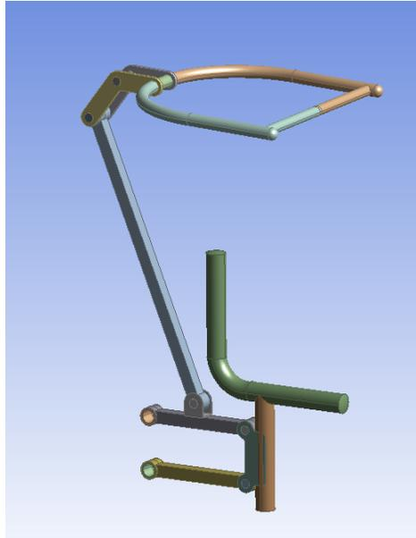
Figura 7.1: Modelo del Ascensor simplificado utilizado para realizar simulaciones en el programa ANSYS (Elaboración propia)
