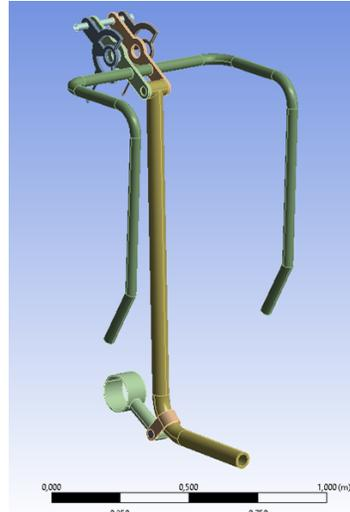
Figura 7.6: Modelo del Elevador simplificado utilizado para realizar simulaciones en el programa ANSYS (Elaboración propia)
