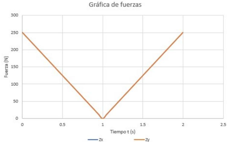
Figura 8.12: Gráfica de la fuerza generada por cada sistema de resortes en el punto Z en sus componentes X y Y (Elaboración propia)
