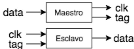
Figura 4.9: Diagrama de entradas y salidas del maestro y esclavo
