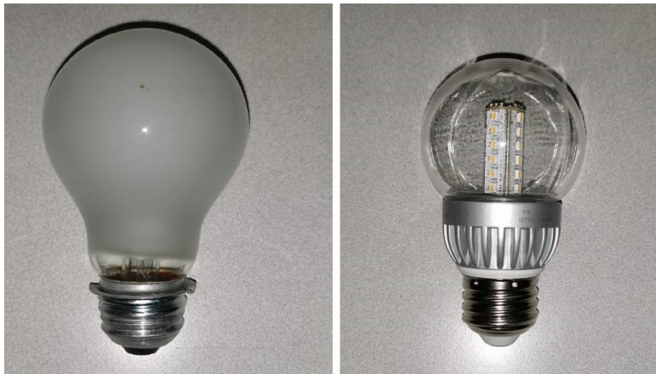
Figura 5.1: Fuentes de luz utilizadas como muestra para estudiar las funciones del equipo (a) bombilla incandescente de 100 W (b) bombilla LED de 2 W.
