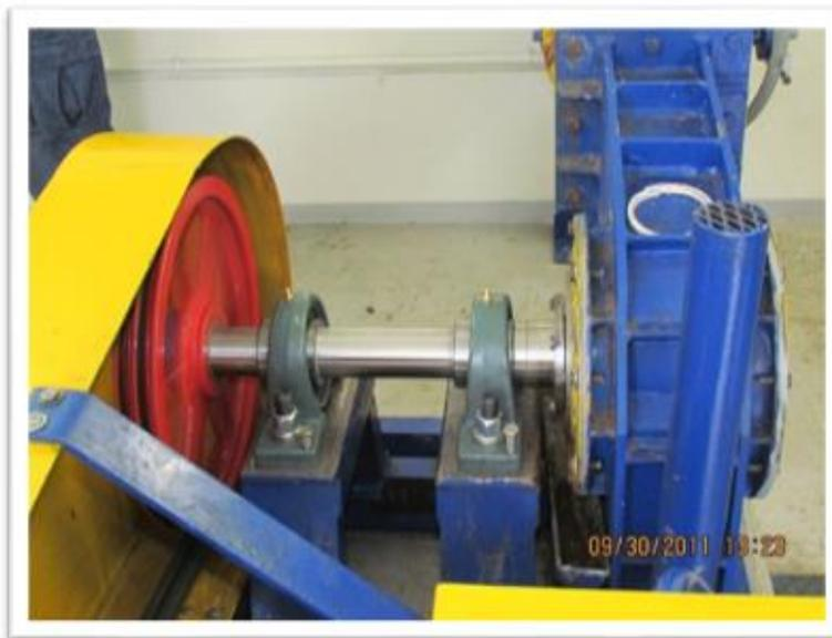
**Figura 4.13 Sistema de transmisión de fuerza, micro-central hidroeléctrica El Páramo-Chirripó.**
