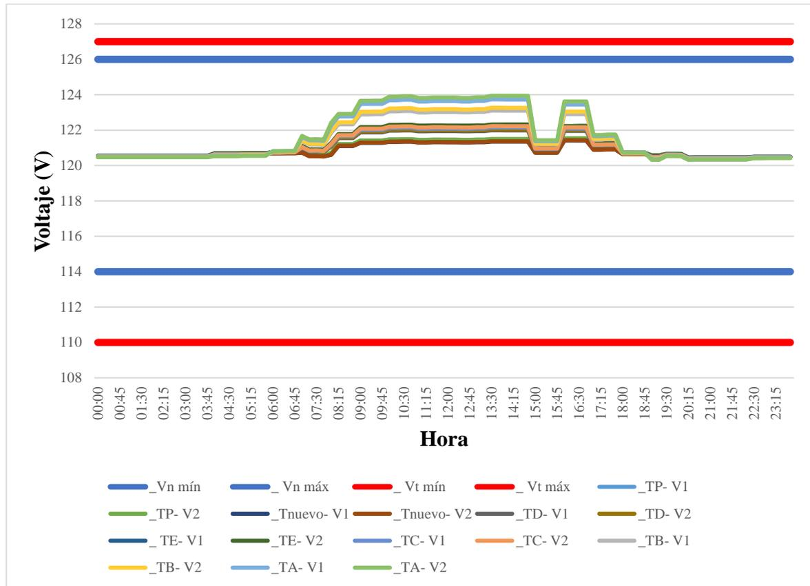
Se simuló la micro-red solamente con los SFV, registrándose la tensión más alta en el SFV del Bloque A, 123,41 V y la tensión más baja en el centro de carga TC, 119,52 V, (cocina y recepción del edificio). El flujo de potencia indica que las pérdidas registradas son del 0.3% de la energía total, ver Anexo 8, A.8.14.
