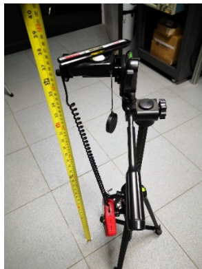
Figura 24. Montaje para las mediciones en una zona que no contiene mueble (LAFTLA). (Confección propia)
