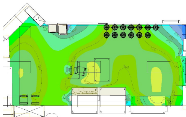
Figura 41. Curvas ISOLUX en el plano útil en local LABORATORIO 1-10. (Tomado de la simulación en DIALUX EVO)
