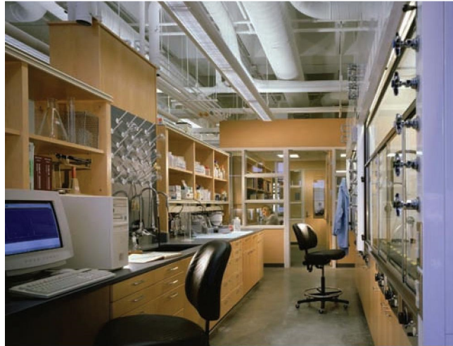
Figura 13. Técnica iluminación Laboratorio Luminaria Directa - Indirecta como capa tarea (Tomada de [16] Página 3)
