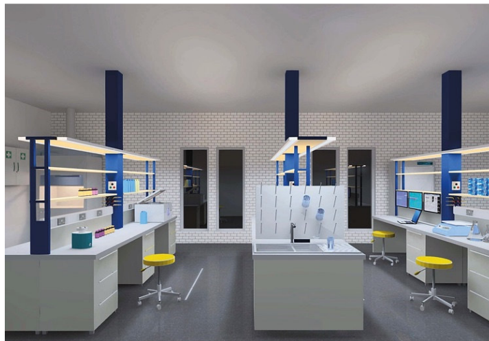
Figura 11. "Esquema downlighting" con luminarias sobre mueble (Iluminación de laboratorios).
