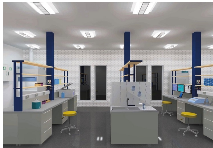
Figura 10. "Esquema downlighting" con luminarias de parche o semi empotradas (Iluminación de laboratorios).
