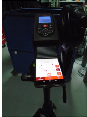
Figura 19. Montaje del medidor de distancia Láser LEICA DISTO X4. (Confección propia)
