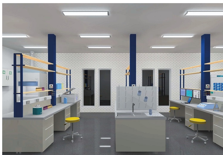
Figura 9. "Esquema downlighting" con luminarias empotradas (Iluminación de laboratorios).
